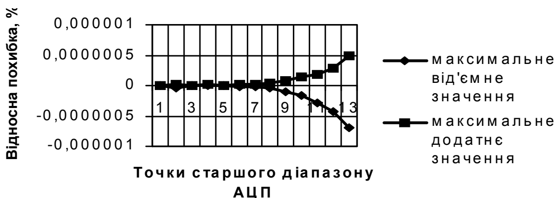
Рисунок 3.7 – Максимальні додатні та від'ємні похибки, зумовлені впливом шумів АЦП на похибку самоперевірки, при рівні шуму 2 розряди
