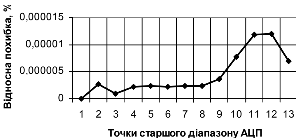
Рисунок 3.6 – Середнє значення похибки, зумовленої розкидом опору резисторів подільника від середнього на 1%, для нижньої половини діапазону перетворення
