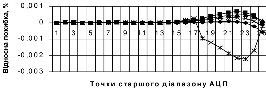
Рисунок 3.4 – Максимальні значення додатної та від'ємної похибок, зумовлені розкидом опору резисторів подільника від середнього на 1%
