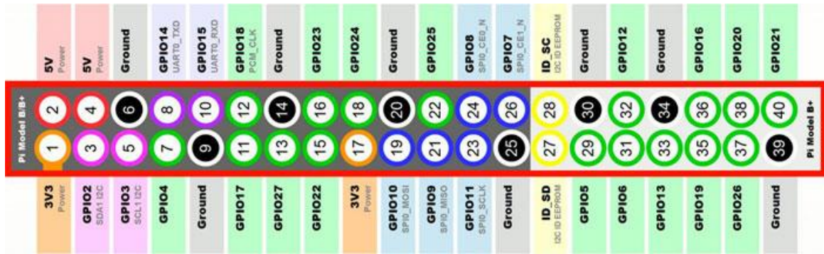
Рис.2.3. Розпіновка GPIO інтерфейсів
