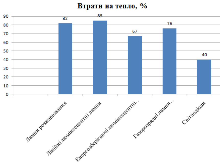
Рисунок 4.2 – Втрати на тепло різних типів джерел світла
