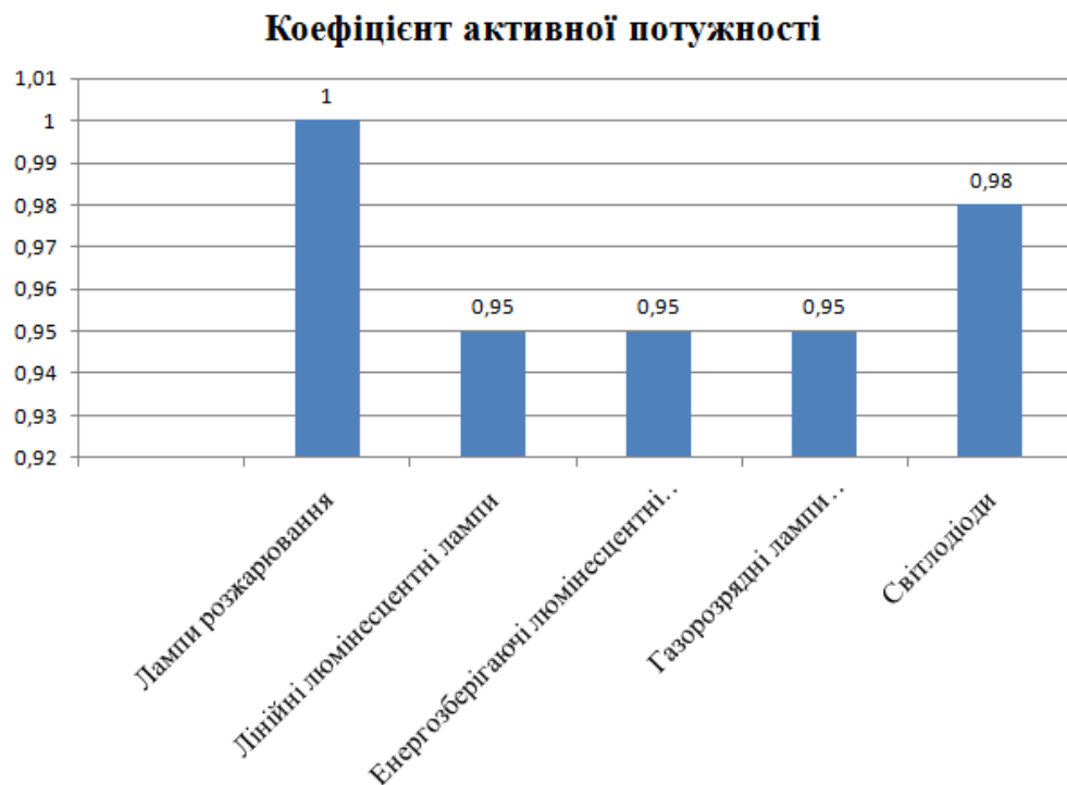
Рисунок 4.5 – Коефіцієнт активної потужності різних типів джерел світла
