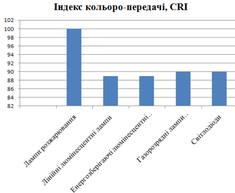
Рисунок 4.3 – Порівняння джерел світла за кольоропередачею
