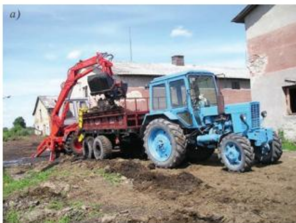
Рисунок 3.7 – Способи завантаження органічних добрив у кузов розкидача:
