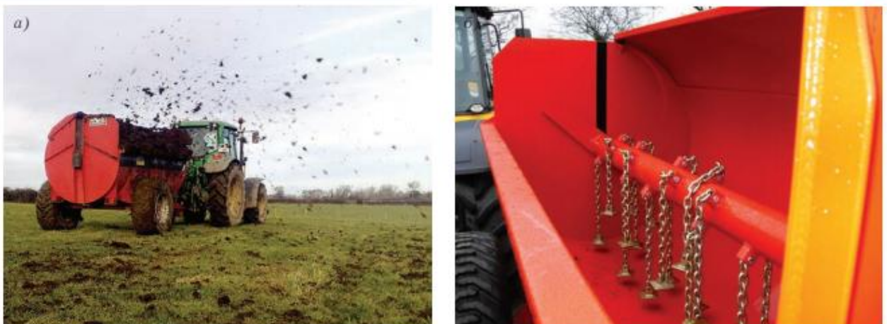
Рисунок 3.3 – Розкидувач органічного добрива Hi-Spec (а) та молотково-ланцюговий розкидаючий пристрій (б)
