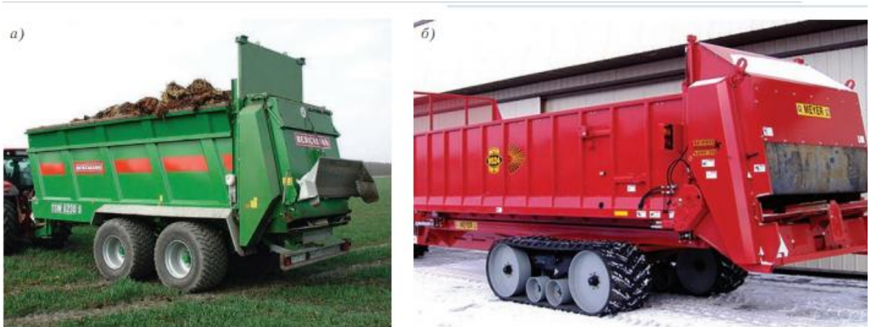
Рисунок 3.6 – Розкидачі з ходовою системою типу «тандем» (а) та гусеничним рушієм (б)
