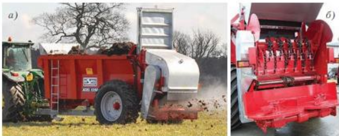
Рисунок 3.4 – Розкидувач органічних добрив Xcel 1200 (а) та молотково-ланцюговий подрібнювальний пристрій (б)
