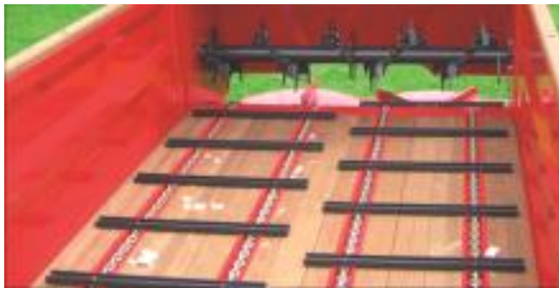
Рисунок 1.2 – Транспортер розкидача УПТС-15
