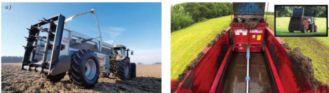
Рисунок 3.1 – „Розкидувач органічного добрива ADS 100 (а) та механізми подавання добрива типа «рухома стінка» (б)»
