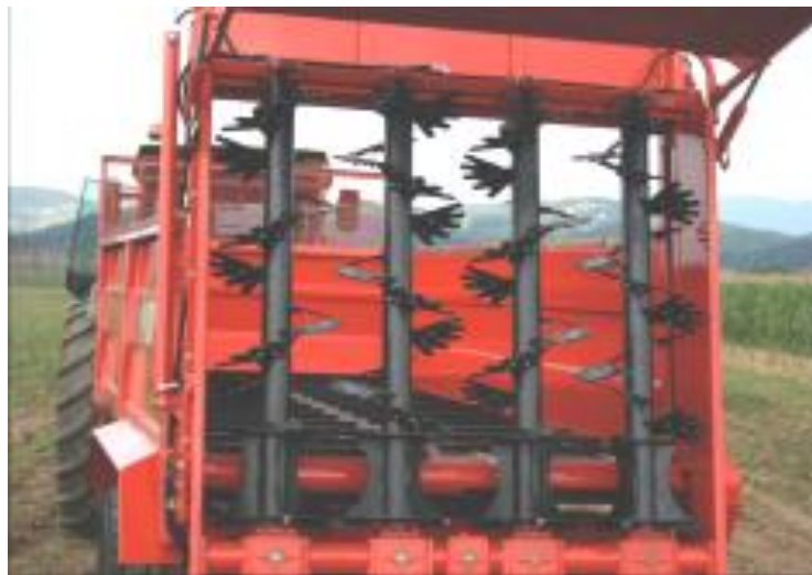
Рисунок 1.8 – Розміщення валів ріжучої головки машини УПТС-15
