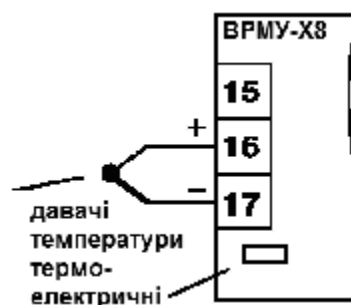
Рисунок 4.3 –Схема підключення «ТП»
