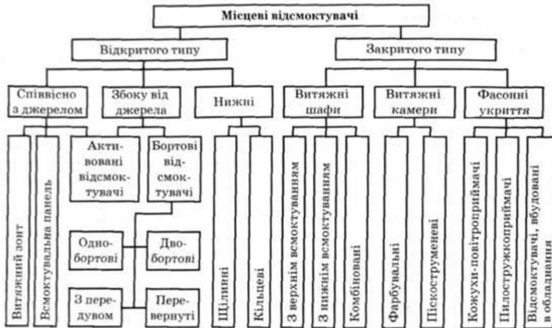
Рисунок 3.2. Класифікація місцевих відсмоктувачів
