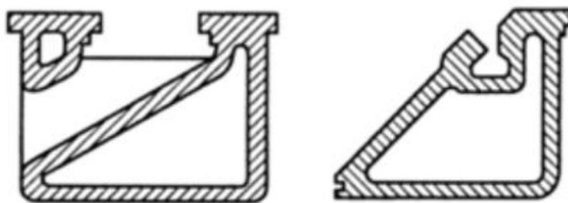
Рисунок 4.4. Типовий переріз нахилених станин
