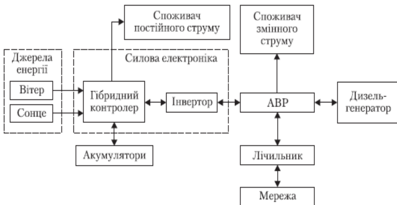
Рис. 2.1 Структурна схема електрозабезпечення на базі гібридної установки сонце – вітер
