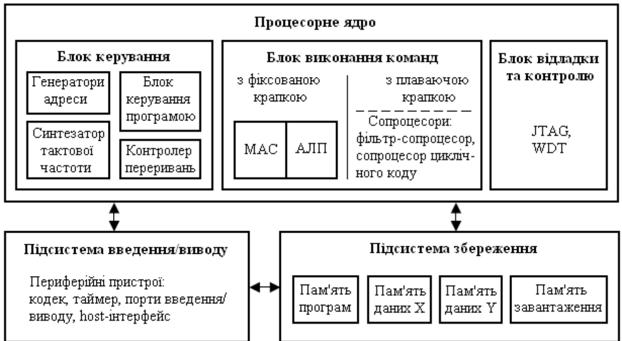
Рис.1.2. Загальна структурна схема ЦСП
