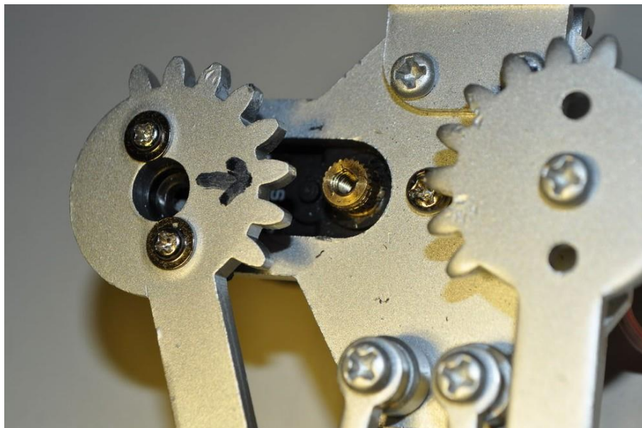
Рисунок 3.3 – Збирання захвату для маніпулятора
