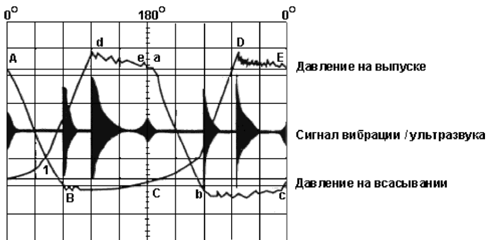
Рисунок 1.7 Тиск у циліндрі компресора (з боку колінчатого вала).
