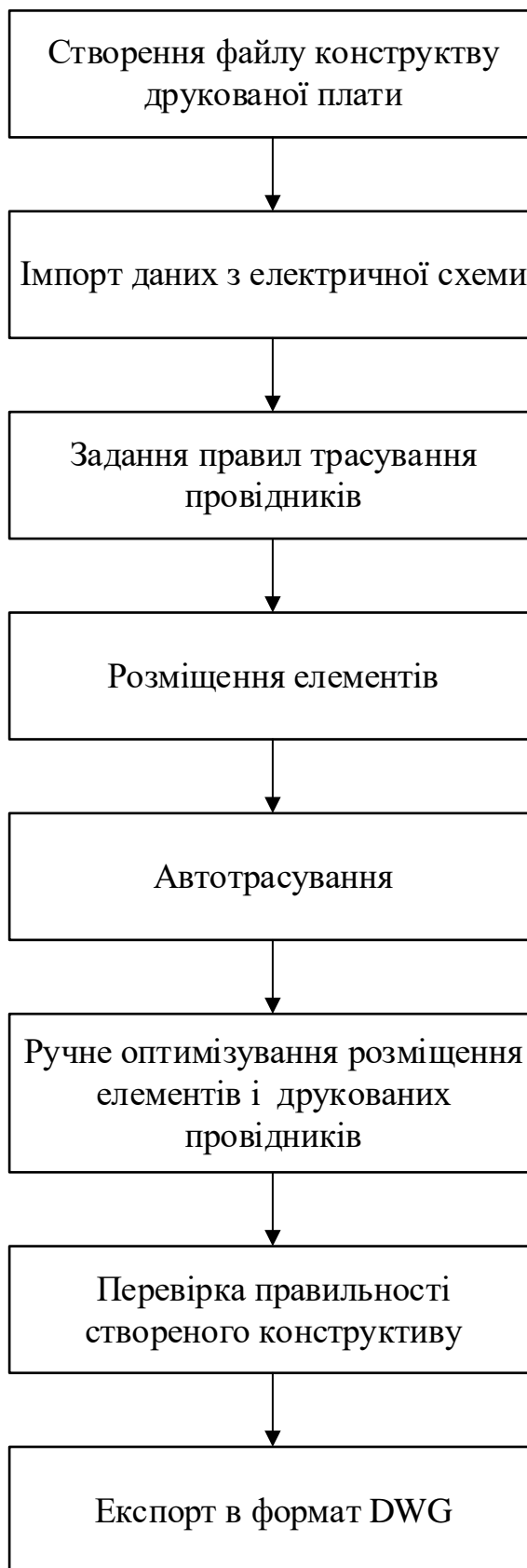
Рисунок 3.17 – Створення конструктиву друкованої плати в Altium Designer
