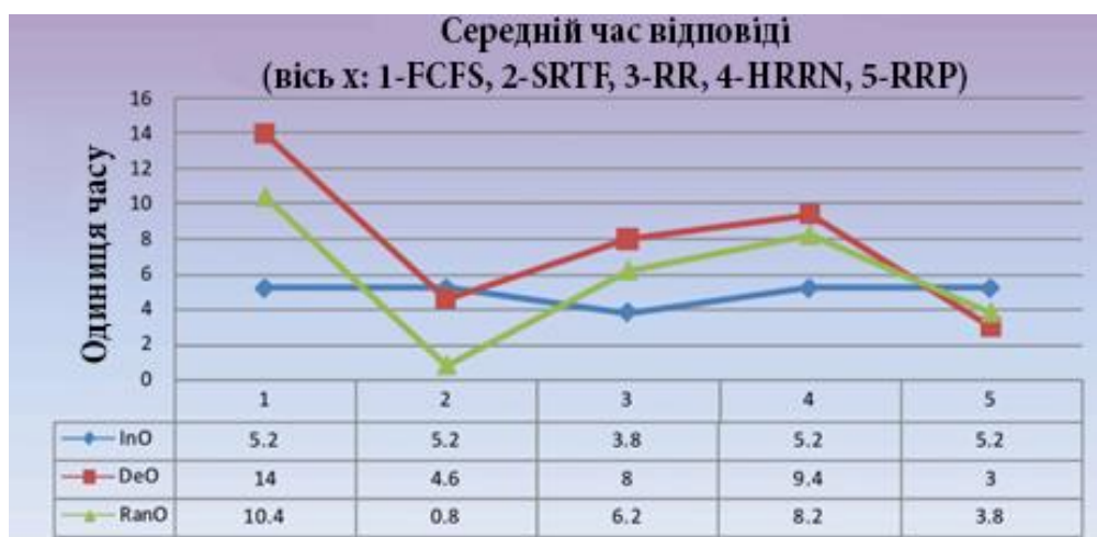
Рис. 3.16. Порівняння швидкості реакції відповіді протоколу VRRP
