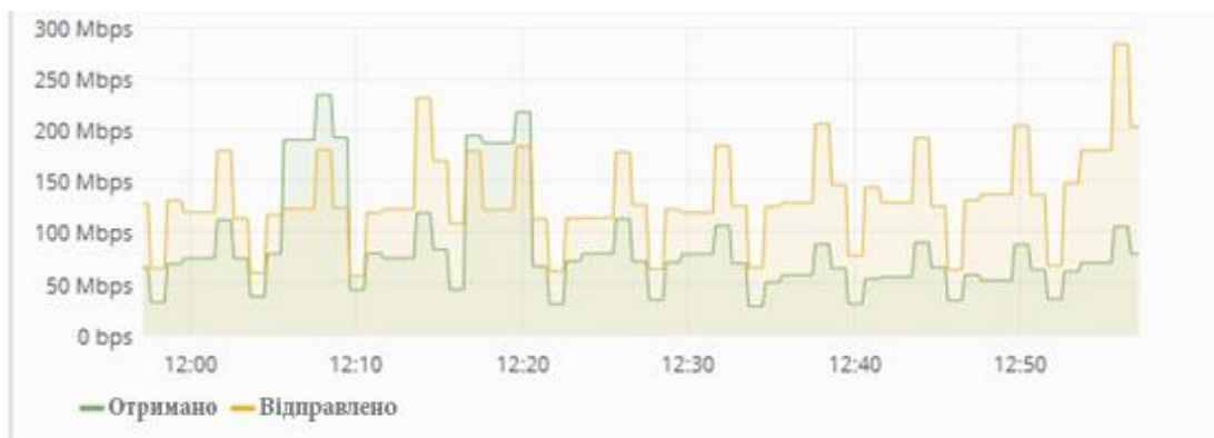
Рис. 3.12. Результати дослідження нетривалого навантаження динамічного агрегованого каналу
