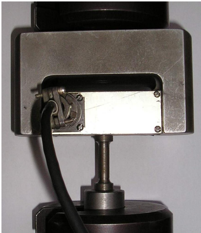
Рис. 5.2. Загальний вигляд тензодинамометра (Пилипенко А.П., Чаусов М.Г.)
