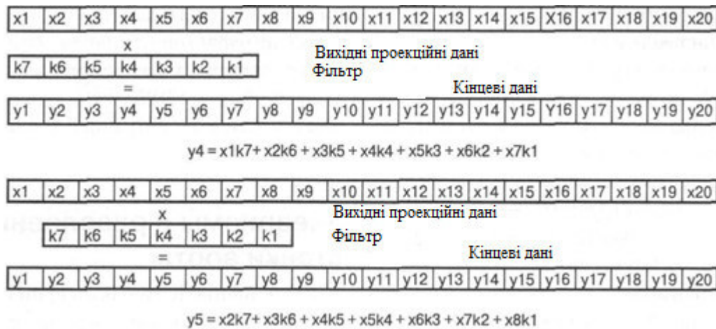
Рис. 2.3. Принцип застосування алгоритму реконструкції (фільтра) для побудови зображення
