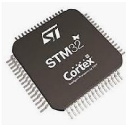
Рисунок 3.2 – Зовнішній вигляд корпусу КМ STM32F107RCT6
