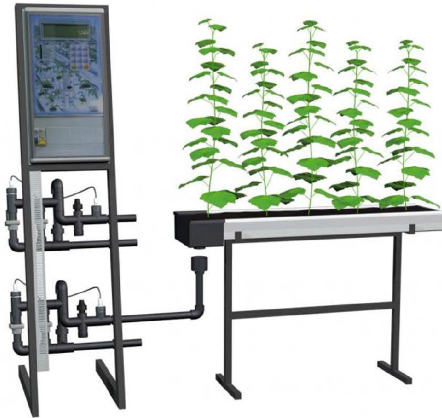
Рисунок 1.8 – Зовнішній вигляд системи вимірювання дренажу
