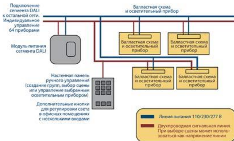
Рисунок 5.2 – Передача данных по мережі DALI.
