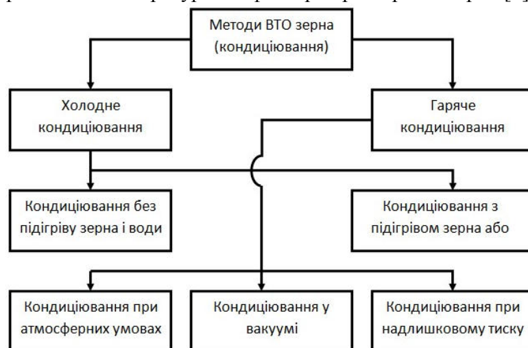
Рисунок 1. Класифікація методів воднотеплової обробки зерна
