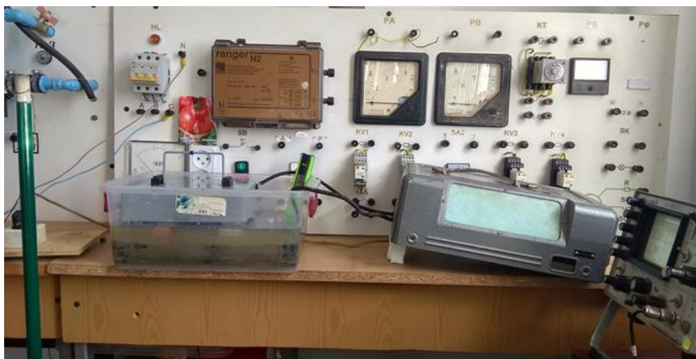
Рис. 2 – Установка для озонування насіння у воді і обробки води високоевльтною напругою
