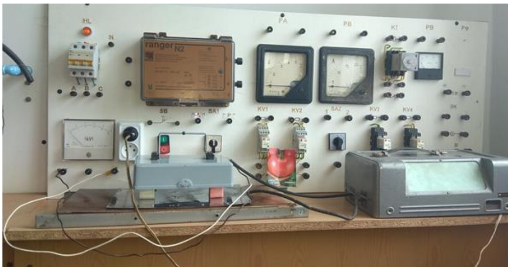
Рис. 1 – Установка для озонування насіння під дією електричного поля високої напруги
