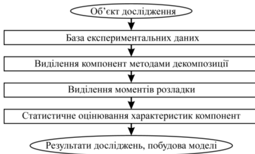
Рисунок 2.5 – Схема поетапної реалізації методології створення моделей СІС із розладкою на основі експериментальних даних
