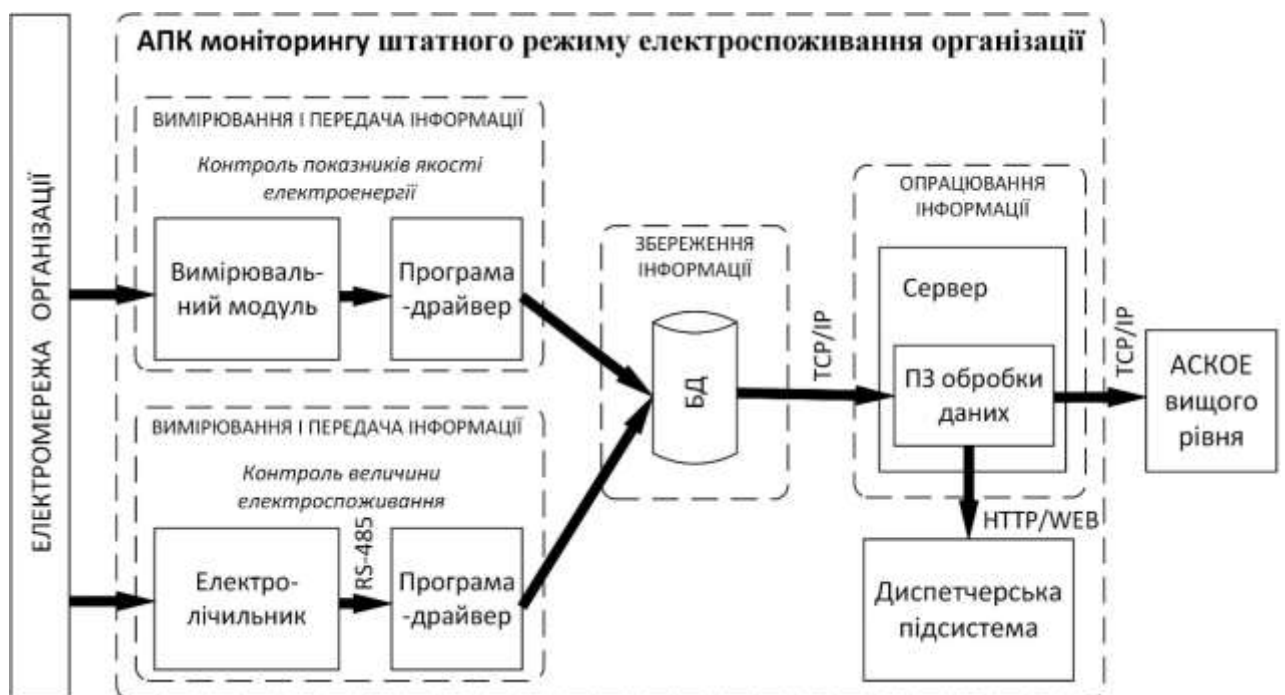
Рисунок 4.1 – Структурна схема АПК для моніторингу штатного режиму електроспоживання організації з контролем показників якості електроенергії
