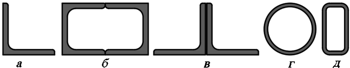
Рисунок 2 – Конфігурації типів перерізів конструктивних елементів ферми: а – одиничний кутник, б – коробка з швеллерів, в – спарені кутники, г – труба, д – гнуто-зварний
