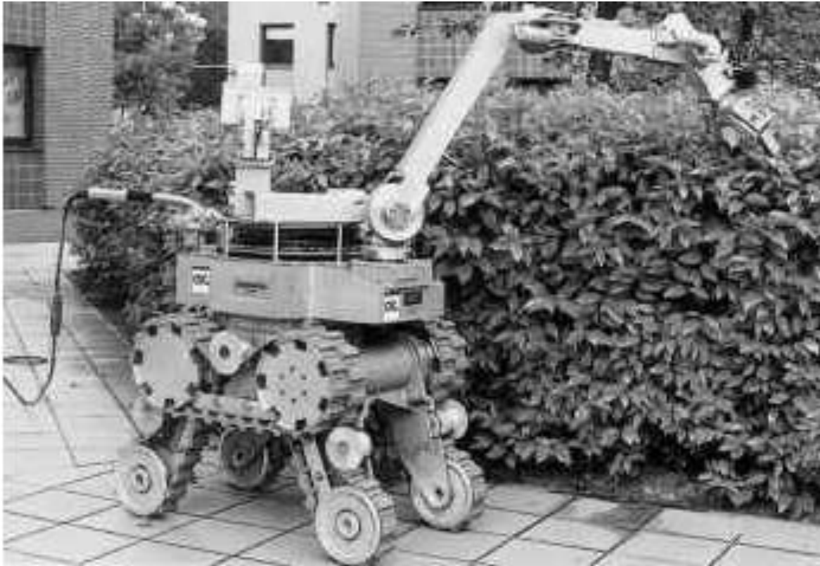
Рисунок 6.1. – Мобільний робот Andros Mk VA (Remotec, США) має адаптивний гусеничний рушій, передня і задня секції гусениць можуть змінювати своє положення, забезпечуючи машині високу прохідність
