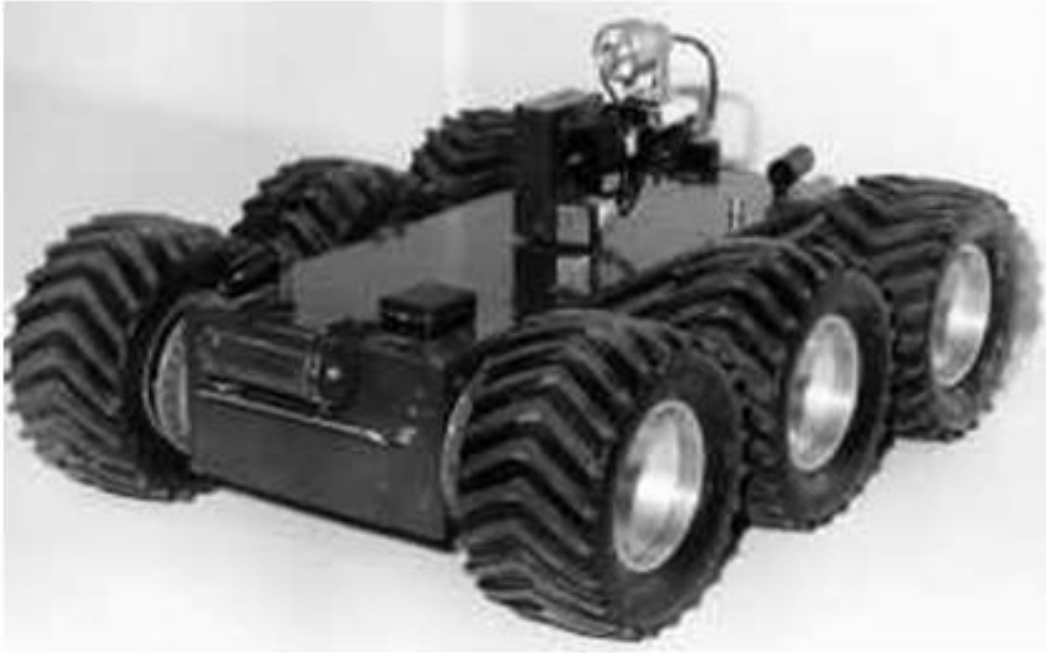
Рисунок 6.3 – Надлегкий мобільний робот МРК-01 (МГТУ ім. Н.Е. Баумана). Призначений для проведення інспекційних перевірок, пошуку та знищення вибухонебезпечних предметів, є базовим зразком для сімейства малогабаритних роботів
