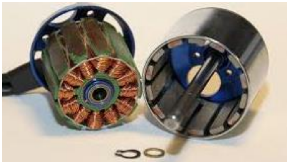
Рисунок 3.2 – Високомоментний двигун обертового руху
