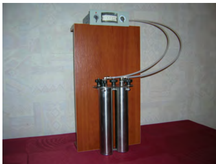
Рис. Лабораторна установка для визначення бродильної активності дріжджів манометричним методом
