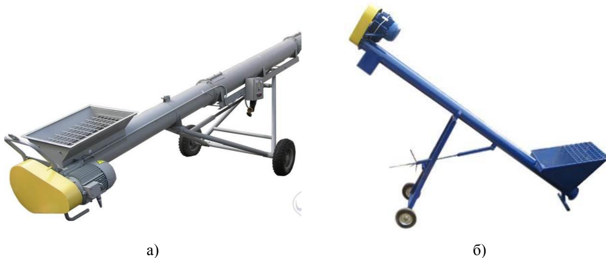
Рис. 1.3. Гвинтові конвеєри з бункерним завантаженням: а) пересувний КВП-60 (ПАТ «ЧеркасиЕлеваторМаш»); б) пересувний конвеєр (ПАТ «Завод Елеваторного Обладнання», м. Кропивницький)
