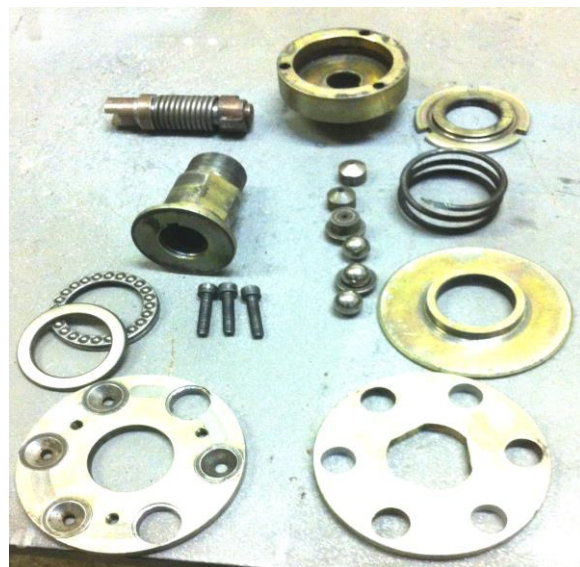
Рис. 3.4. Загальний вигляд пружно-запобіжної муфти у розібраному вигляді
