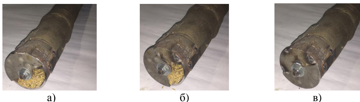
Рис. 3.9. Вигляд стану регульованого вивантажувального отвору експериментальної установки: а) відкритий; б) напівзакритий; в) закритий
