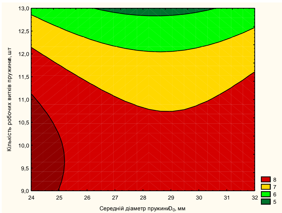
Рис. 4.9. Поверхня відгуку (а) та двовірний переріз поверхні відгуку (б) залежності кругного моменту T_{кр} для циліндричної пружини ( d = 4 мм)
