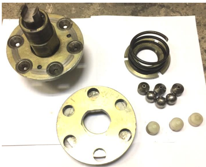
Рис. 3.4. Загальний вигляд пружно-запобіжної муфти у розібраному вигляді
