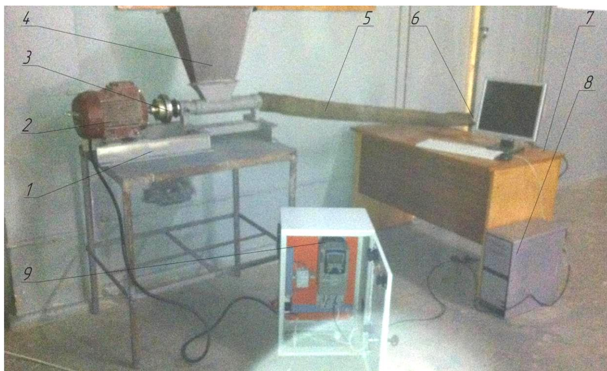
Рис. 3.8. Загальний вигляд експериментальної установки для дослідження привода гнучкого гвинтового конвеєра оснащеного пружно-запобіжною муфтою
