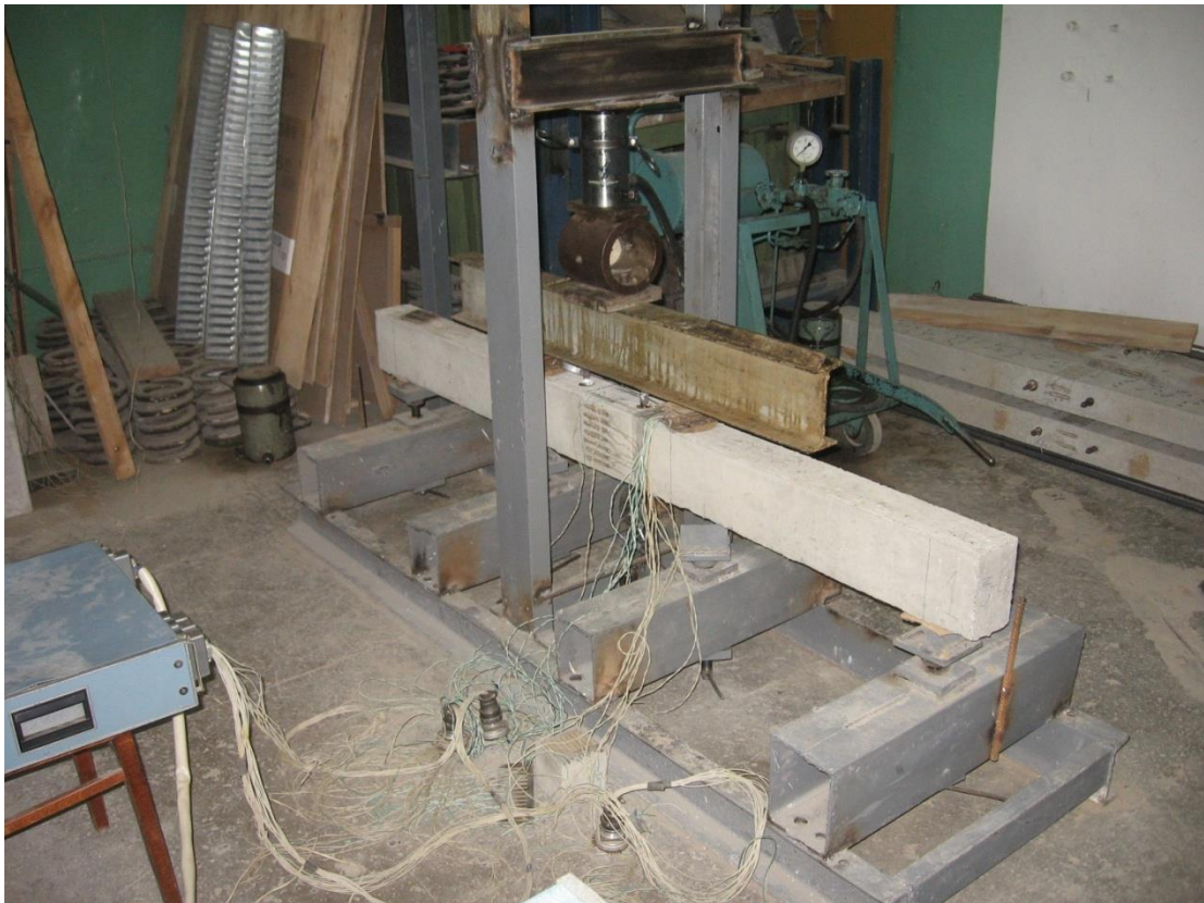
Рисунок 4 – Дослідна балка в установці для випробування
