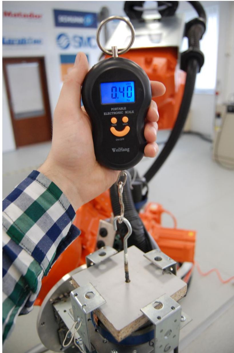
Рис. 3.2 Вимірювання сили притягання захоплювального пристрою
