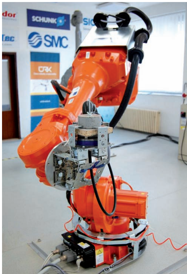
Obr. 3 Konfigurácia robota IRB 4600-60 s celým experimentálnym usporiadaním
