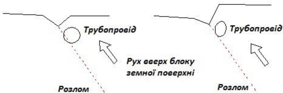
Рис. 2 – Схема деформацій трубопроводів на зонах розлому
