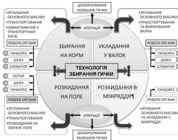
Рис. 2. Технології та операції збирання гички коренеплодів
