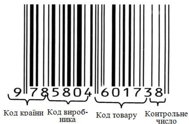
Рисунок 2 – Код EAN-13, зовнішній вигляд і структура
