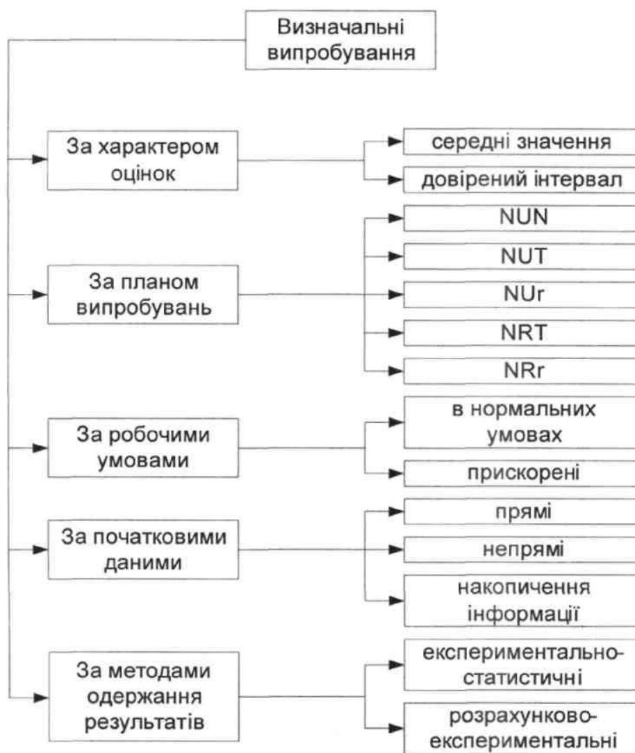
Рисунок 7.2. Класифікація визначальних випробувань на надійність
