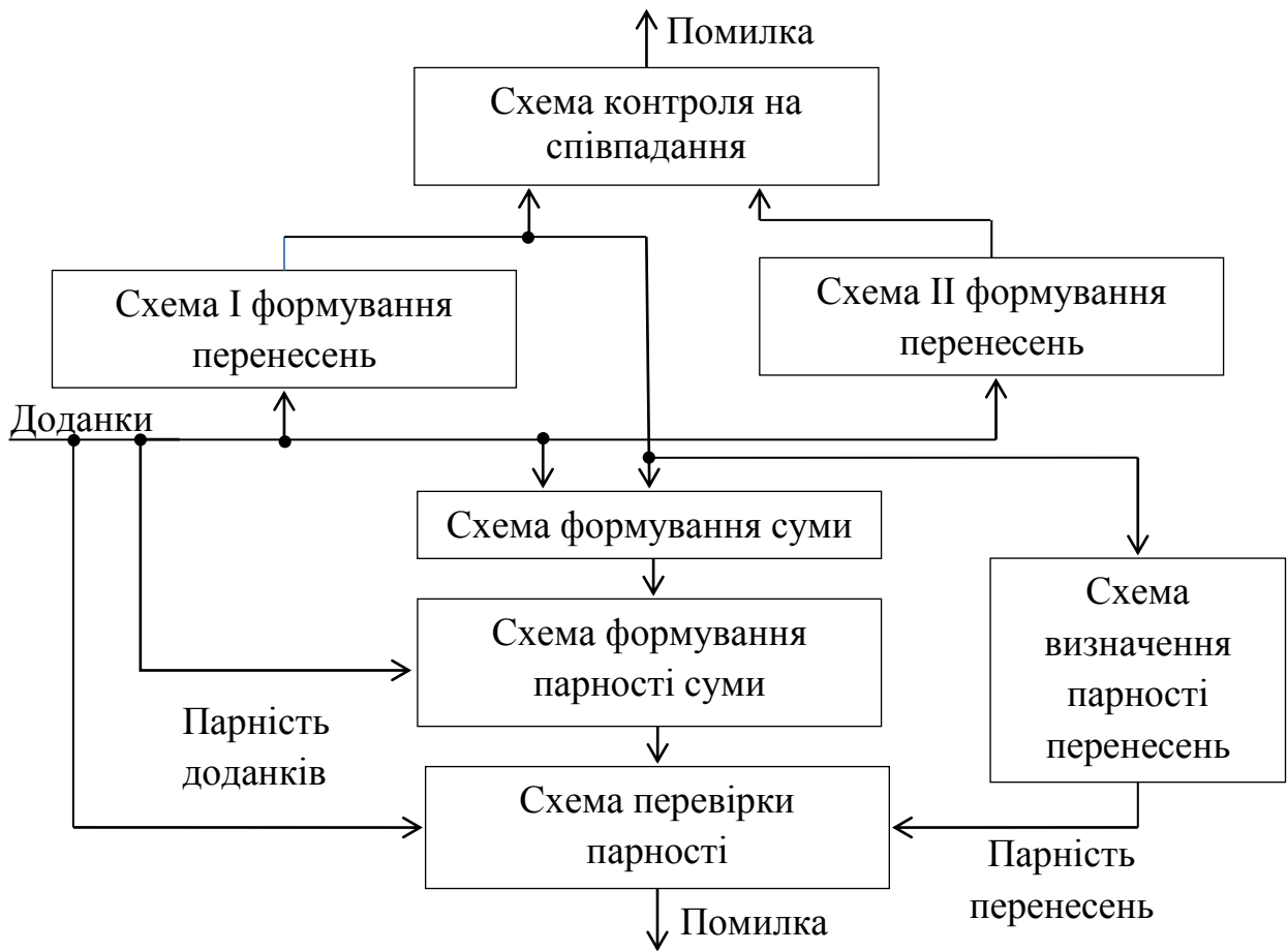
Рисунок 12.1. Схема контролю операції додавання з використанням перевірок на парність
