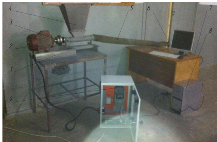
Рис. 3. Загальний вигляд експериментальної установки для дослідження привода гвинтового конвеєра оснащеного пружно-запобіжною муфтою
