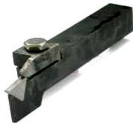
Рис. 1. Відрізний різець з бічною установкою БНП
