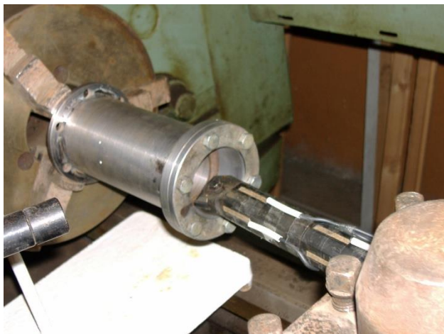
Рис. 3. Світлина пристрою для проведення процесу розточування НГЗ
