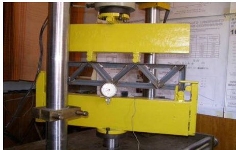
Рисунок 2 – Дослідження фізичної моделі зварної ферми
