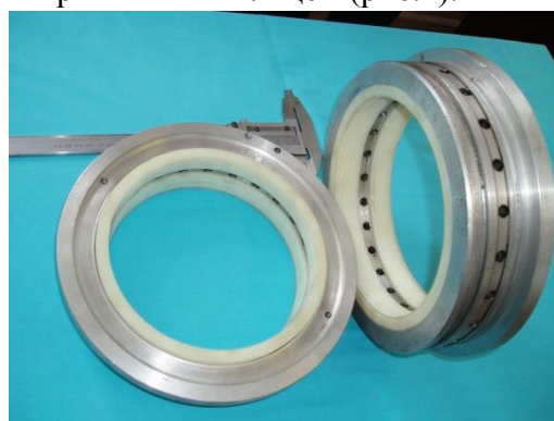
Рисунок 1 – Конструкція пластмасо-металевого лабіринтного ущільнення відцентрового нагнітача фірми «Нуово Піньоне» ГТК-25I
