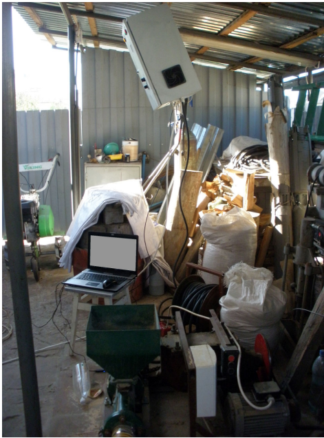
Рисунок 5. Загальний вигляд станда для дослідження процесів транспортування матеріалів гвинтовими та шнеково-пневматичними механізмами
