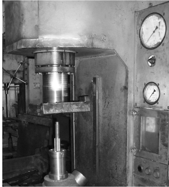
Рис. 18. Експериментальна установка для визначення зусилля дорнування напівкруглих канавок шліцьових валів на гідравлічному пресі мод. П6320
