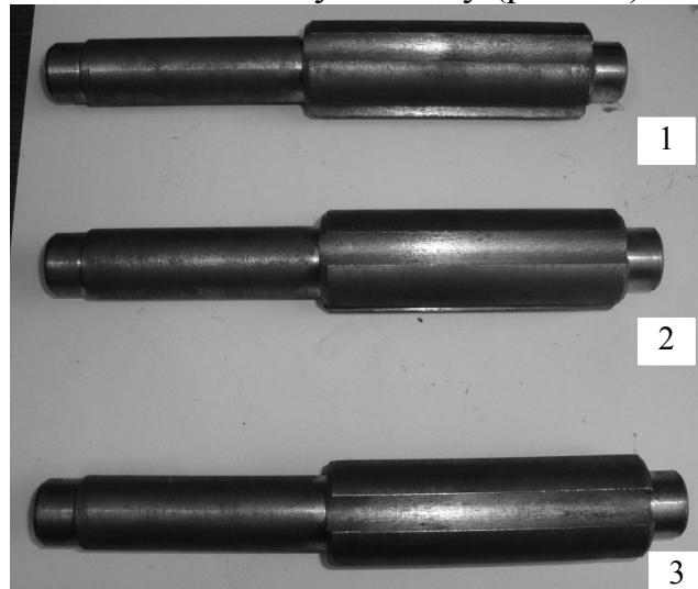
Рис. 15. Дослідні зразки шліцьових валів з напівкруглими канавками: 1 – сталь 45; 2 – сталь 40ХН; 3 – сталь 20Х
