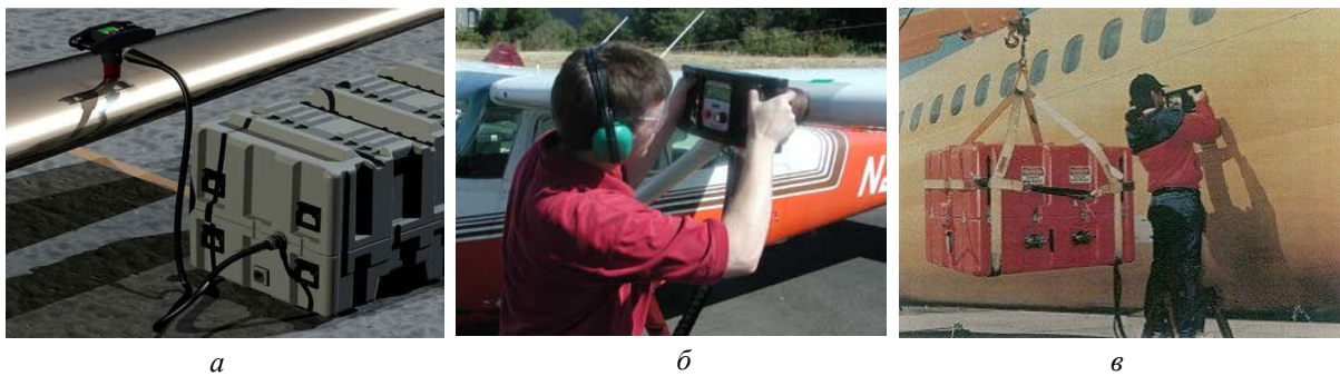
Рисунок 1 – Магнітно-імпульсні комплекси для зовнішнього рихтування корпусів літаків: а, б – фірми «Fluxtronic»; в – фірми «Electroimpact»
