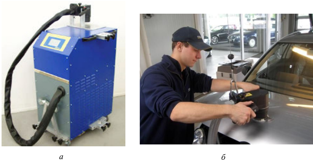
Рисунок 2 – Магнітно-імпульсна установка фірми «Tesla»: а – загальний вигляд; б – установка в роботі
