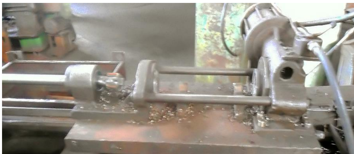
Рис. 5.1. Фотографії проведення виробничих випробувань інструменту: а) після встановлення інструменту (перед початком роботи); б) в процесі оброблення; в) після закінчення оброблення та зняття деталі
