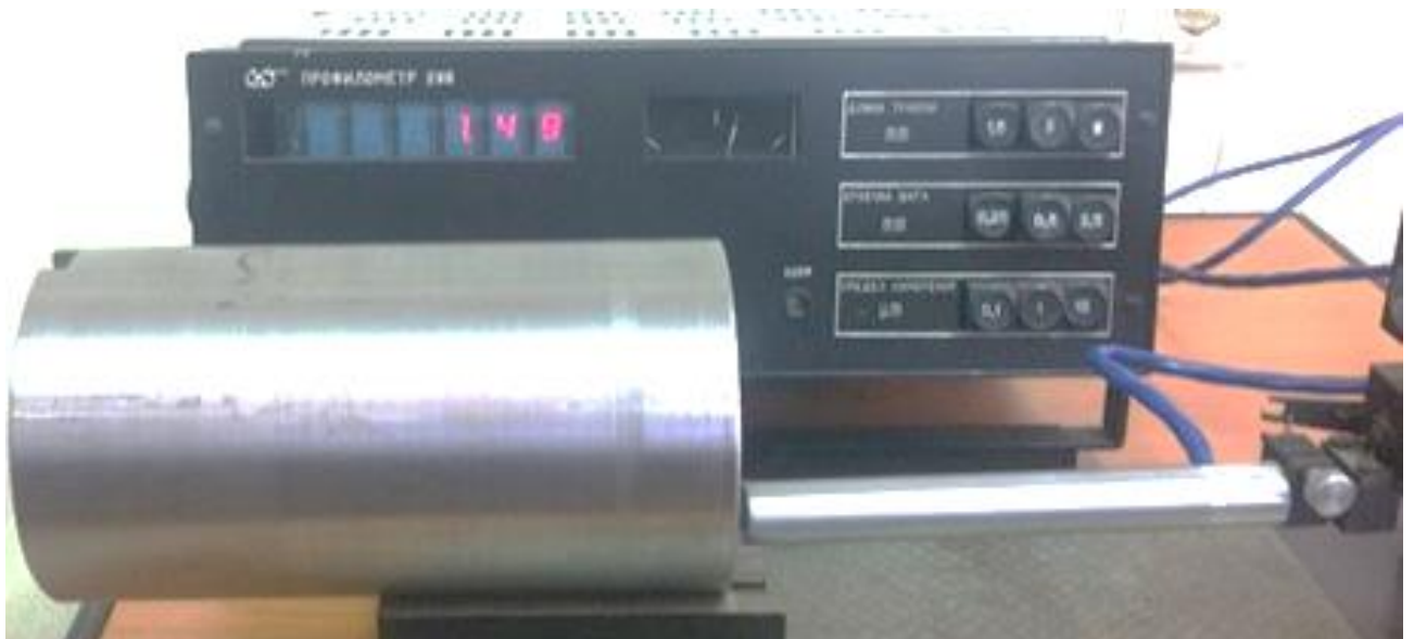
Рис. 5.5. Вимірювання параметру Ra на профілометрі мод. 283
