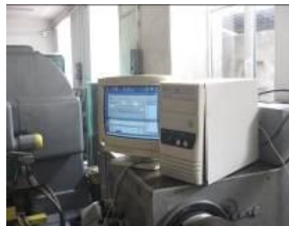
Рисунок 1. Фото багаторізцевої головки і експериментального стенду для тонкого точіння з пружними напрямними та електромагнітним приводом встановлених на токарно-гвинторізному верстаті 16К20
