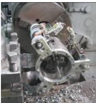
Рисунок 1. Фото багаторізцевої головки і експериментального стенду для тонкого точіння з пружними напрямними та електромагнітним приводом встановлених на токарно-гвинторізному верстаті 16К20
