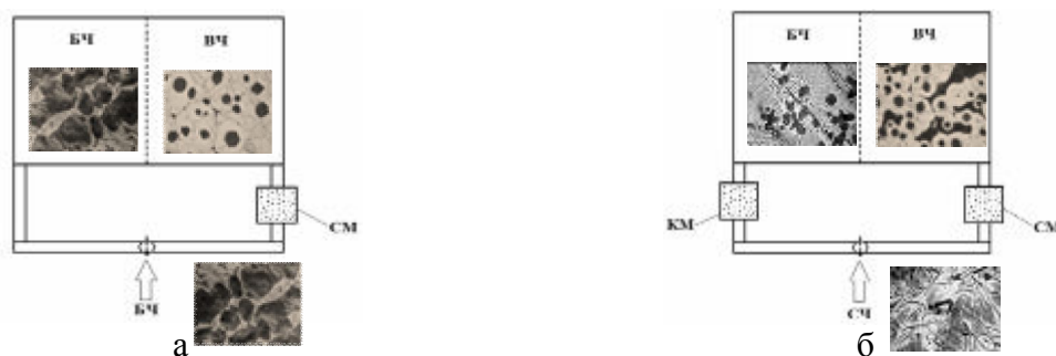
Рисунок 1 – Схема технологічних варіантів отримання двобічних виливків з білого (БЧ) і високоміцного (ВЧ) чавунів на базі вихідного білого (БЧ) (а) або сірого (СЧ) (б) чавунів, з роздільним модифікуванням металу в ливарній формі сфероїдизувальним (СМ) та карбідостабілізуювальним (КМ) модифікаторами
