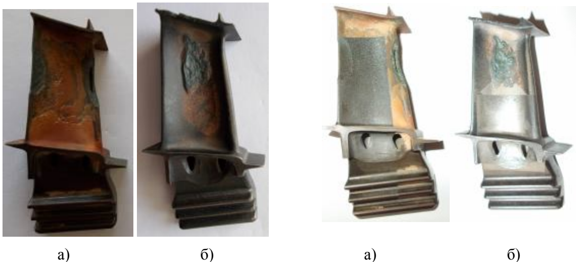
Рис. 3. Следы ВТ-коррозии (а) и эксплуатационного нагара (б) на поверхности лопатки турбины
