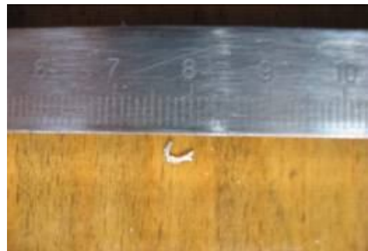
Рисунок 3. Зразки стружки після обробки деталі багаторізцевою головкою адаптивного типу з пружними напрямними та електромагнітним приводом.
