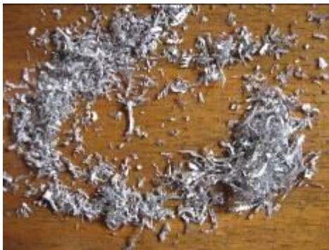
Рисунок 3. Зразки стружки після обробки деталі багаторізцевою головкою адаптивного типу з пружними напрямними та електромагнітним приводом.
