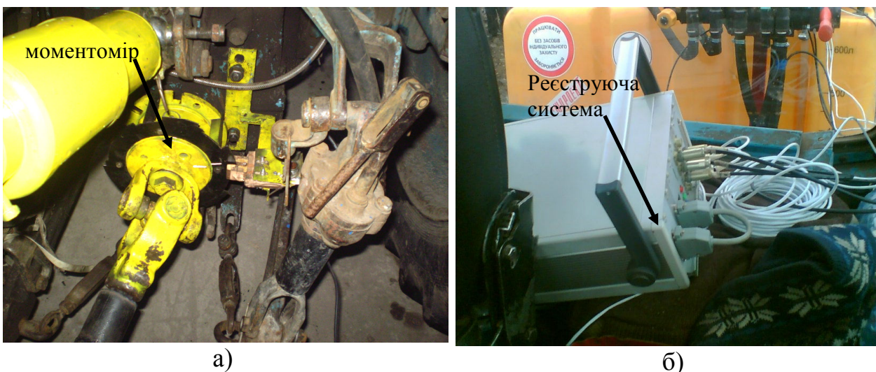
Рис.4. Розміщення обладнання при проведенні експерименту: а-моментомір; б-реєструюча система.
