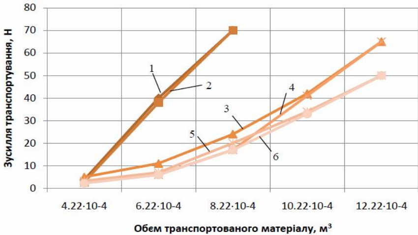
Рисунок 3. Зміна зусилля переміщення сипкого матеріалу залежно від його об'єму 1 — пшениця без використання повітряного підживлення; 2 — пшениця з використанням повітряного підживлення; 3 — тирса без використання повітряного підживлення; 4 — тирса з використанням повітряного підживлення; 5 — висівки без використання повітряного підживлення; 6 — висівки з використанням повітряного підживлення
