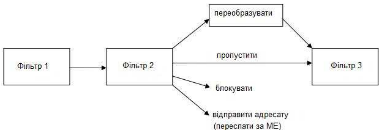
Рис. 2.2. Схема фільтрації в МЕ
