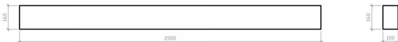
Рис. 2.1 Опалубочне креслення дослідних зразків
