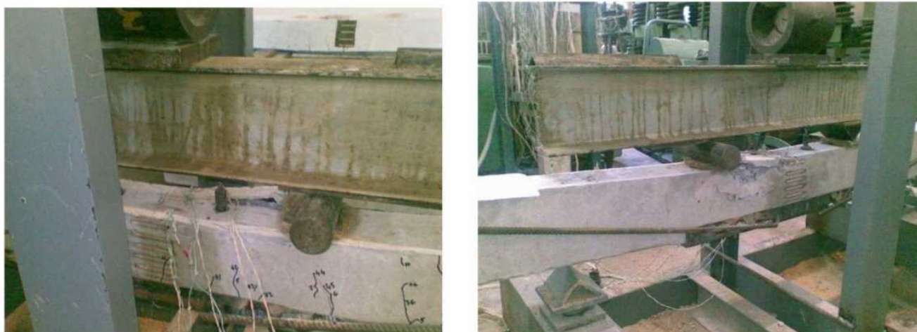
Рис.3.1. Характер руйнування дослідних балок
