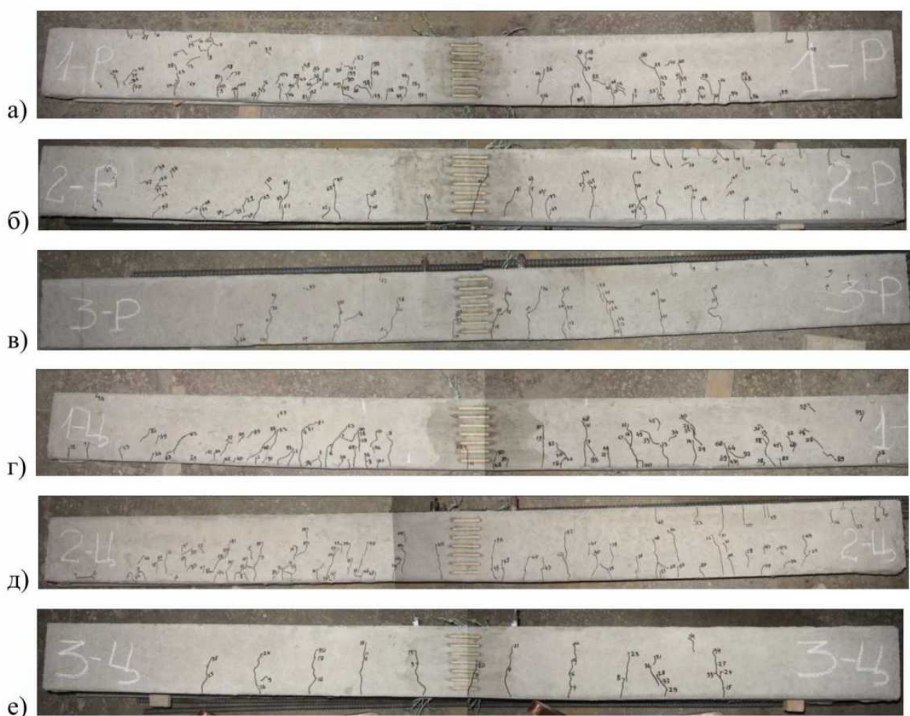
Рис. 3.13. Дослідні балки після проведення випробувань (для кращої оглядовості підсилення перед фотографуванням було знято)
