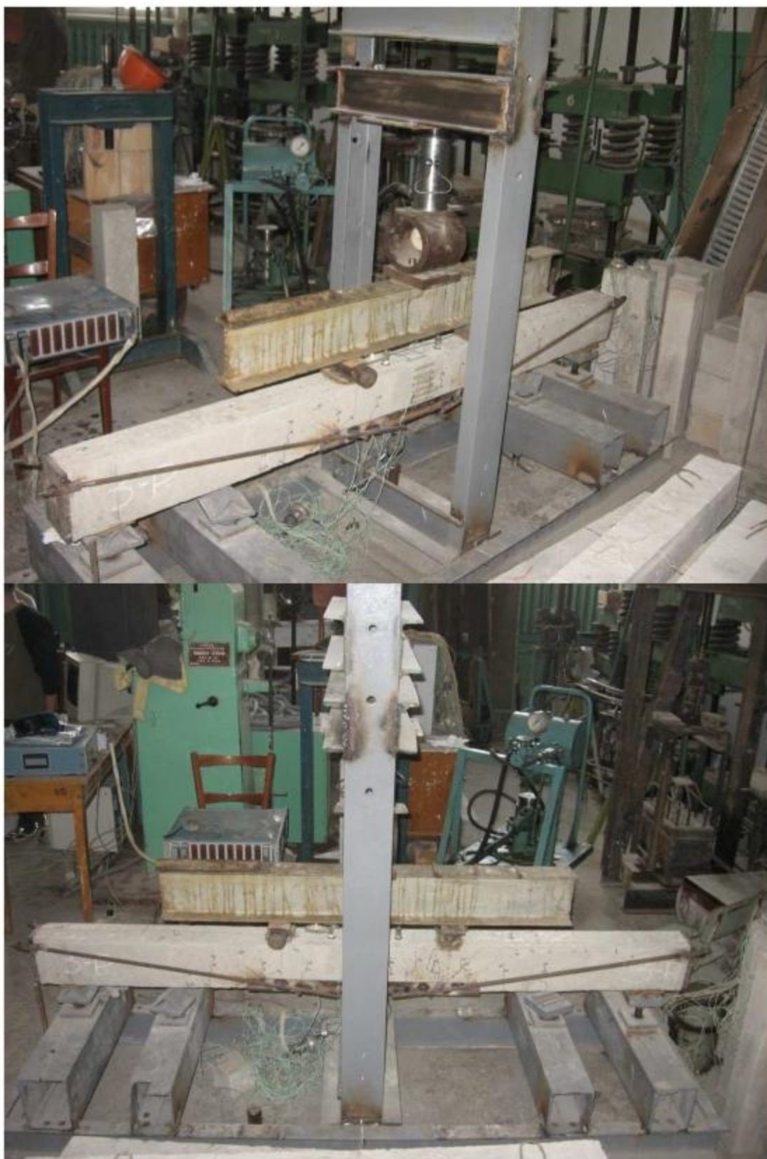
Рис. 2.6 – Випробування підсиленого дослідного зразка
