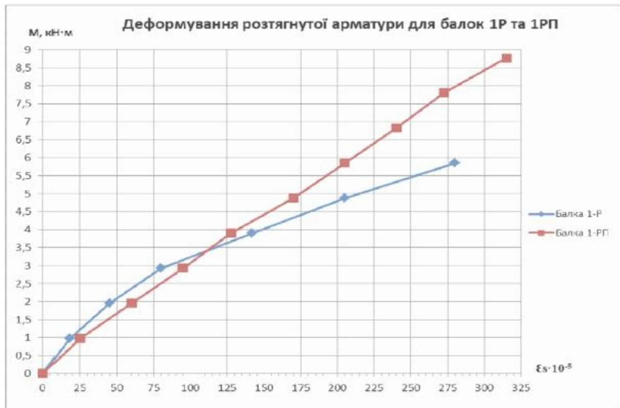
Рис. 3.11 – Графік відносних деформацій робочої арматури балок 1-Р та 1-РП
