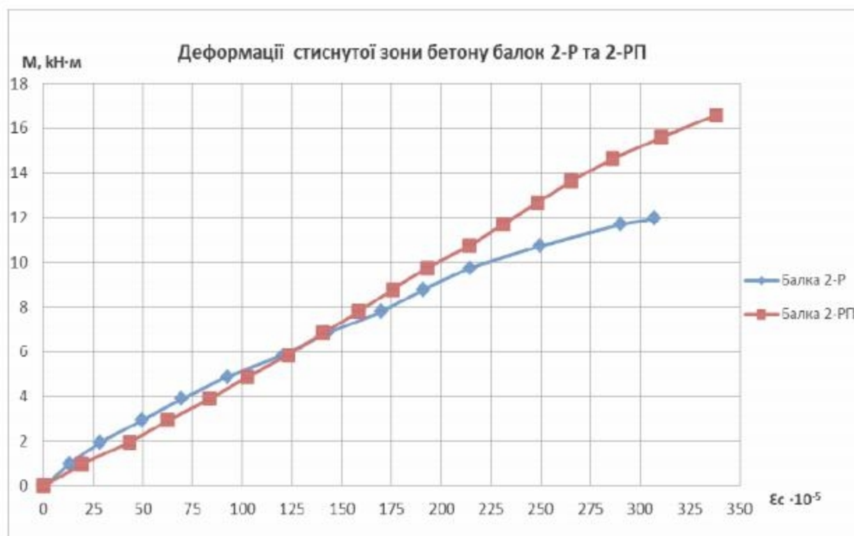
Рис. 3.4 – Графік відносних деформацій стиснутого бетону балок 2-Р та 2-РП
