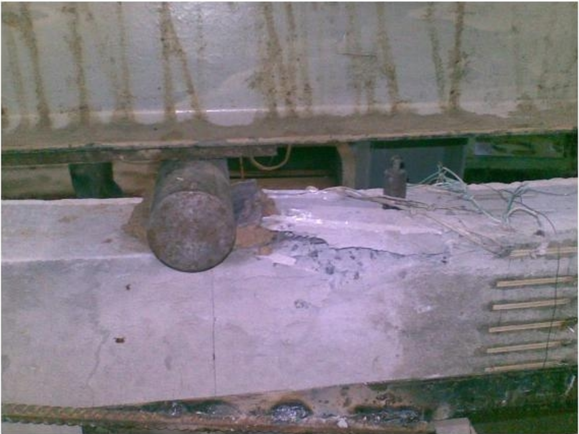
Рис. 3.2 – Виколювання стиснутої зони бетону дослідних балок
