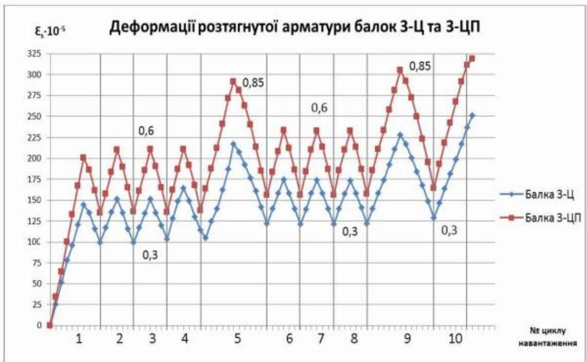
Рис 3.17 – Графік відносних деформацій розтягнутої арматури балок 3-Ц та 3-ЦП.
