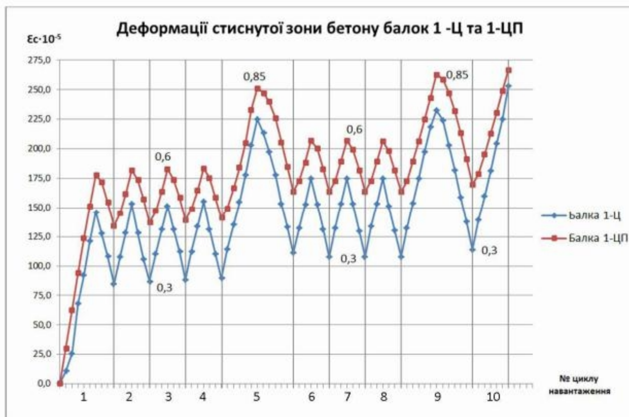
Рис. 3.7 – Графік відносних деформацій стиснутого бетону балок 1-Ц та 1-ЦП
