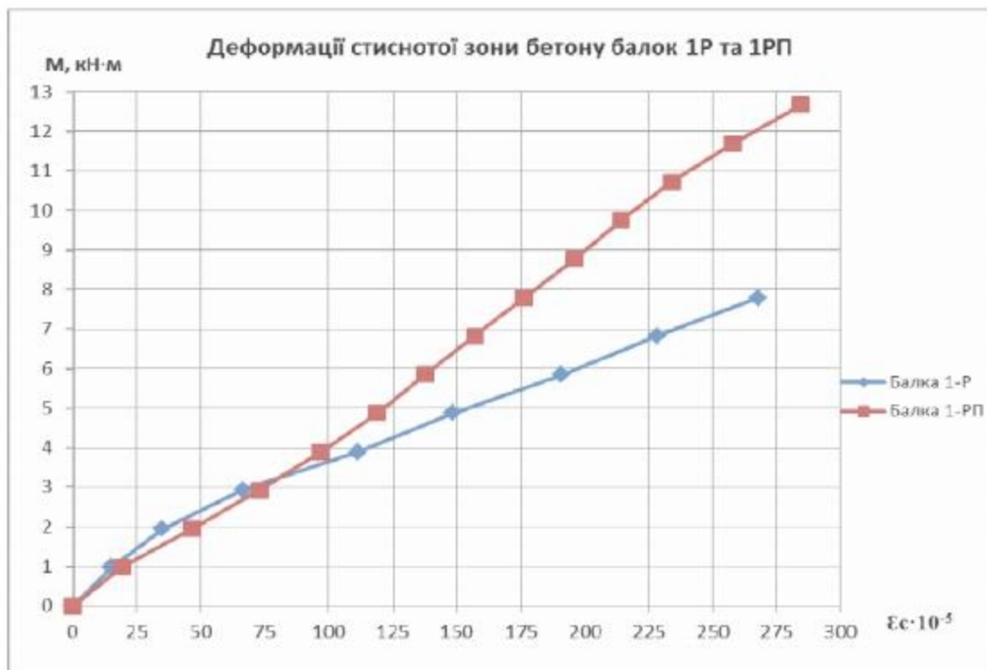
Рис. 3.3 – Графік відносних деформацій стиснутого бетону балок 1-Р та 1-РП
