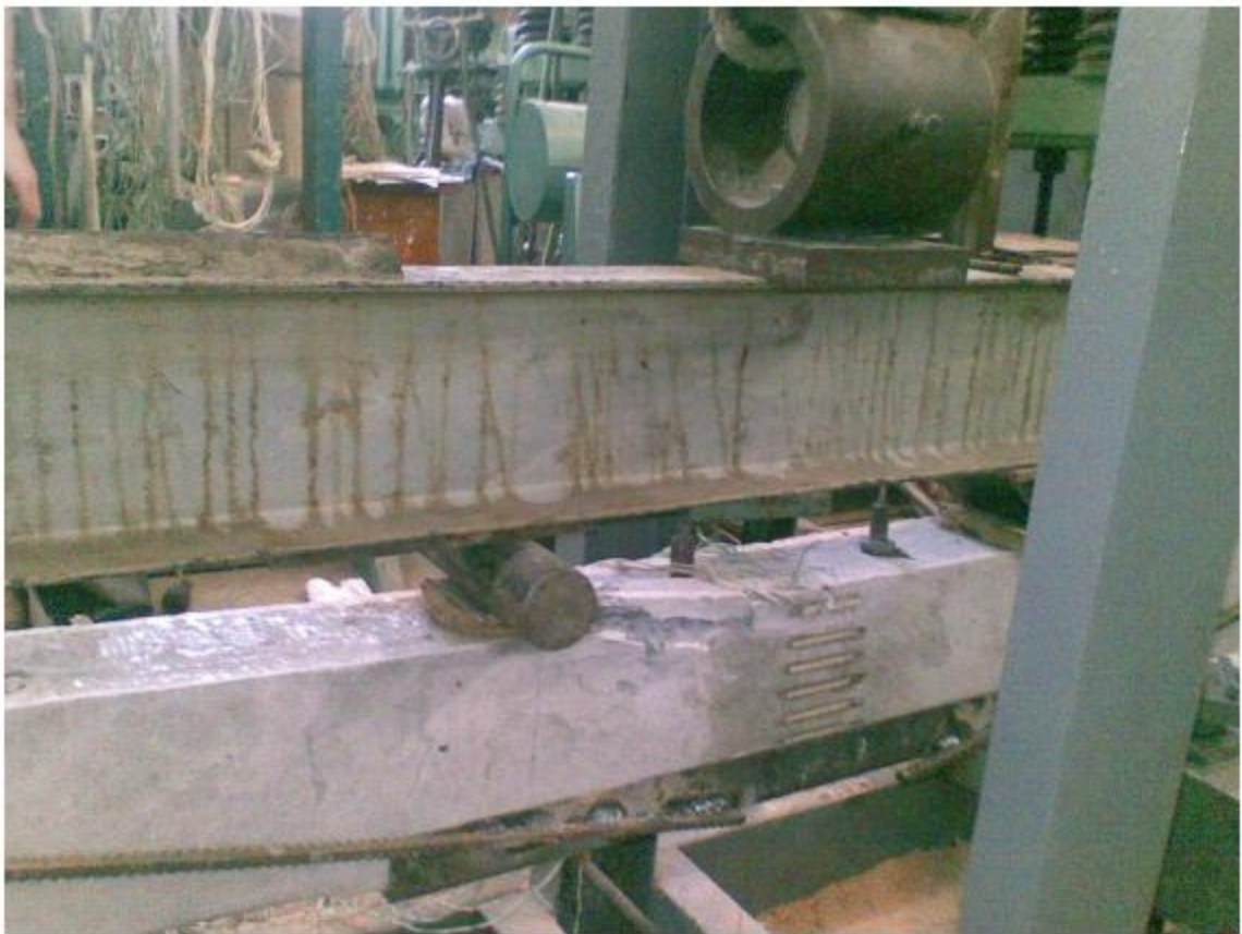
Рис. 3.1 – Характер руйнування підсиленних дослідних зразків
