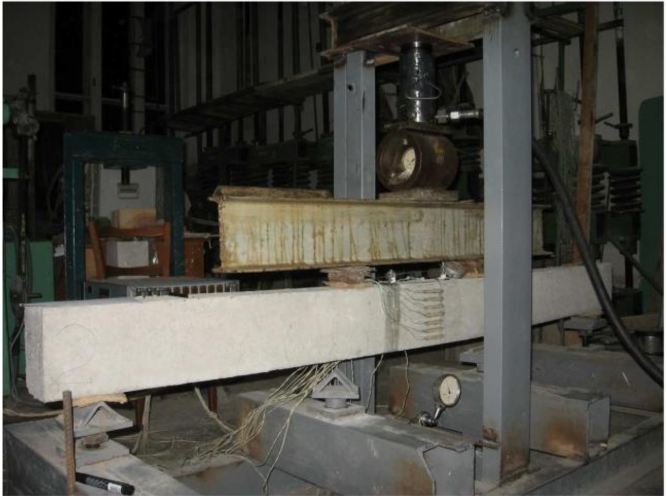
Рис. 2.3 – Загальний вигляд дослідної балки в установці для випробувань
