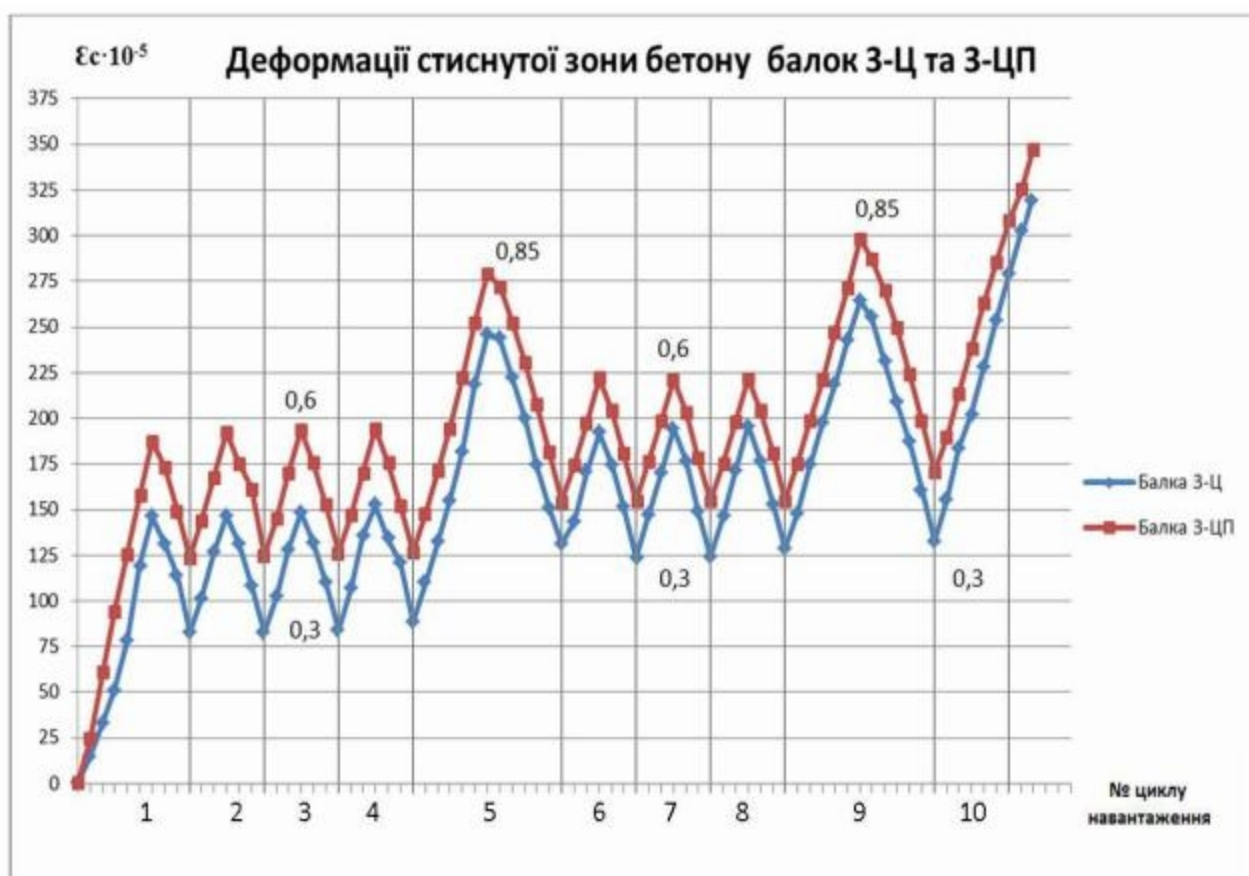
Рис. 3.9 – Графік відносних деформацій балок 3-Ц та 3-ЦП
