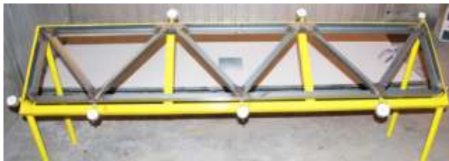
Рис. 1 – Експериментальна установка для натурального експерименту з встановленим дослідним зразком ферми
