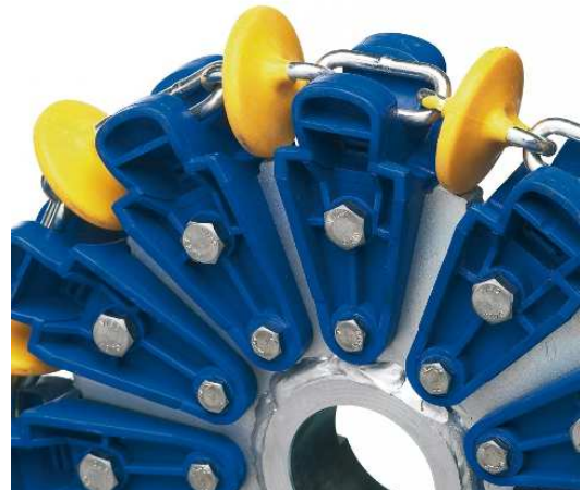
Рисунок 3 – Робочий орган шайбового конвеєра фірми “Limatex Agro”
