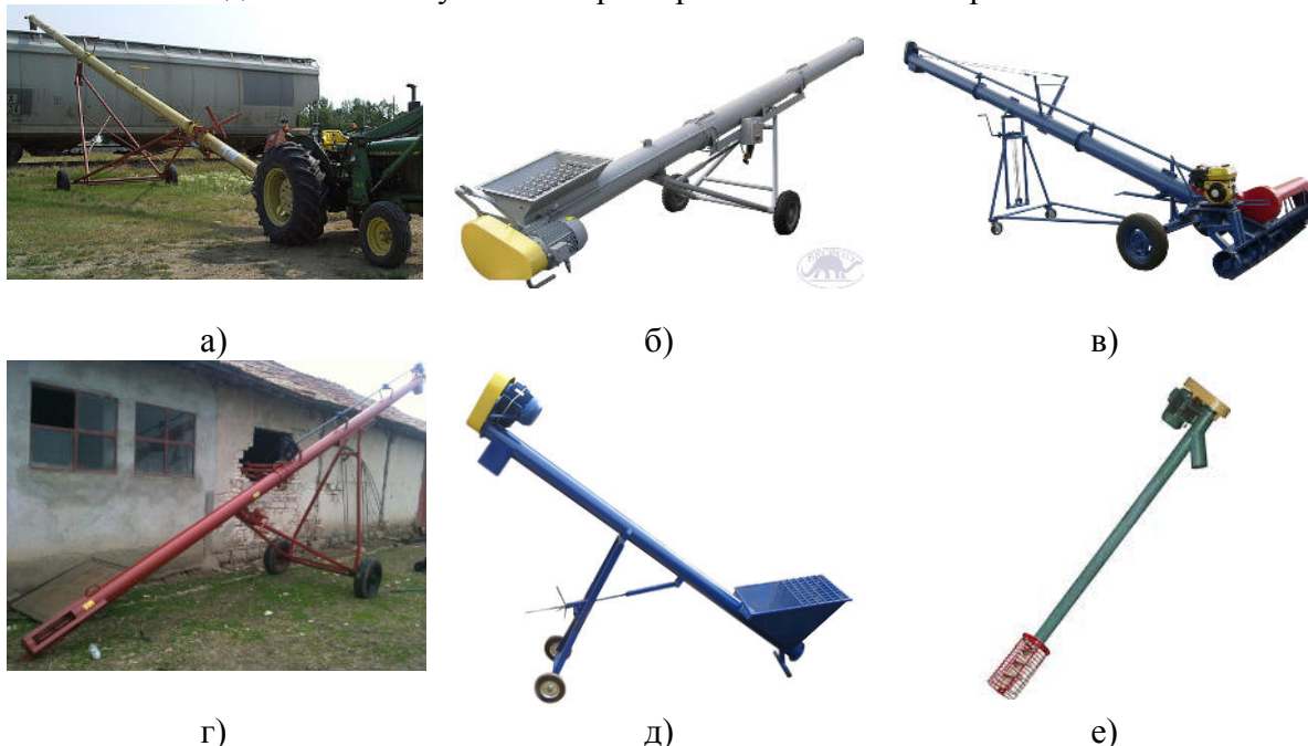
Рисунок 1. Гвинтові завантажувачі-транспортери: а) John Deere tractor, Canada; б) КВП-60 ПАТ «ЧеркасиЕлеваторМаш»; в) шнековий ПАТ «Гарант-Агро», м. Кривий Ріг; г) ЕТ «КИСИ-Иван Маринов», Болгарія; д) пересувний ПАТ «Завод Елеваторного Обладнання», м. Кіровоград; е) ООО «Флона», Білорусія
