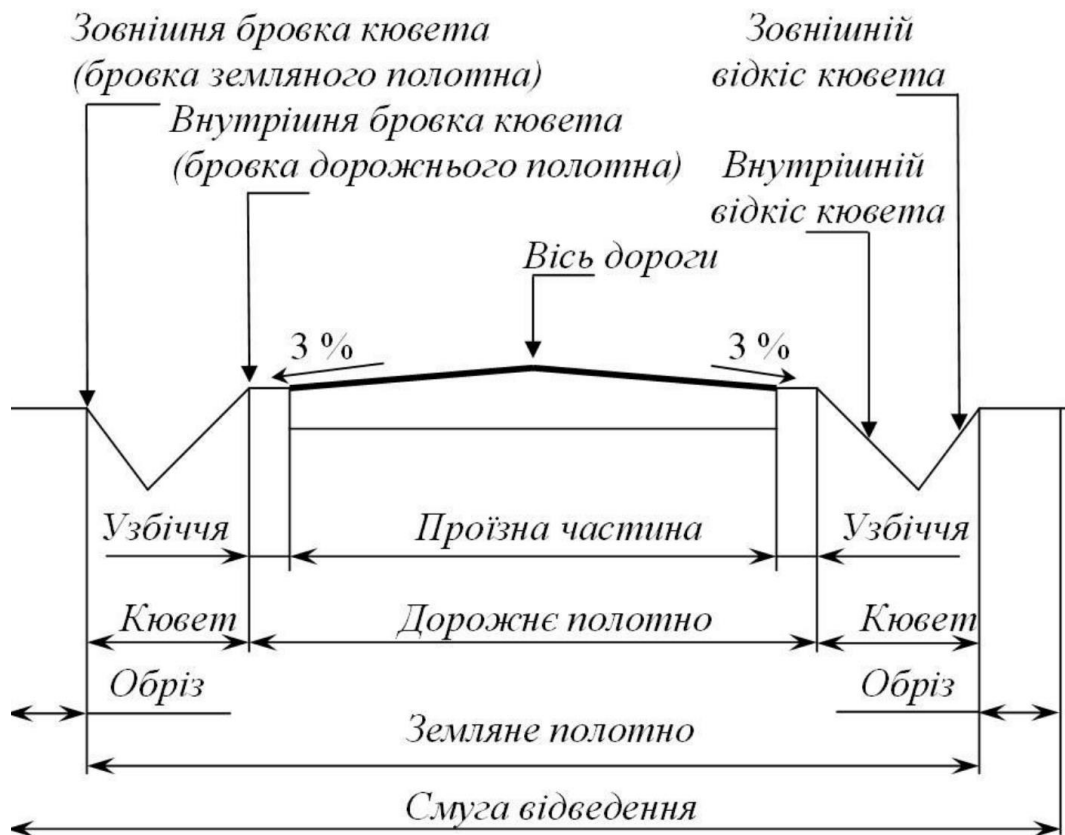
Рисунок 20 - Основні елементи конструкції військових автомобільних доріг
