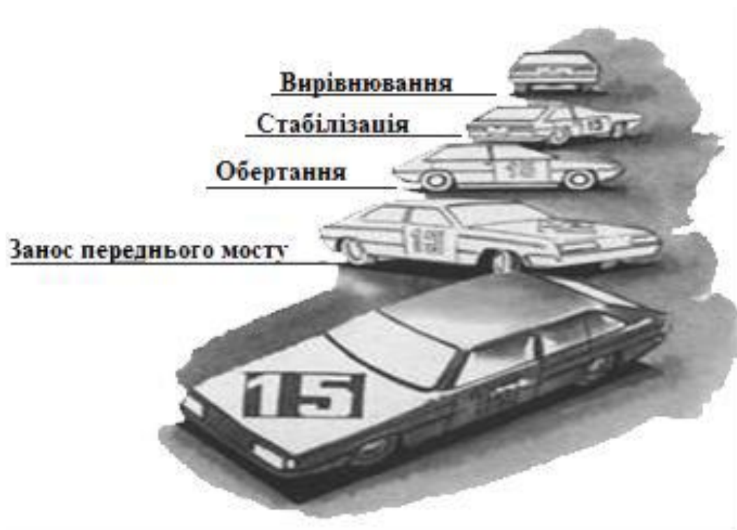
Рисунок 25 - Подолання серії імпульсів ритмічного заносу
