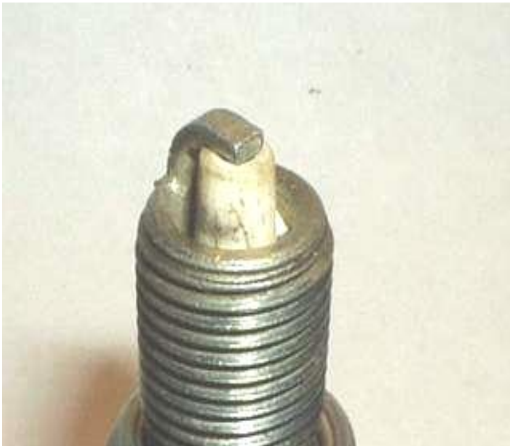
Рисунок 1.4 - Обрив ізолятора. Помітний при перевертанні свічки
