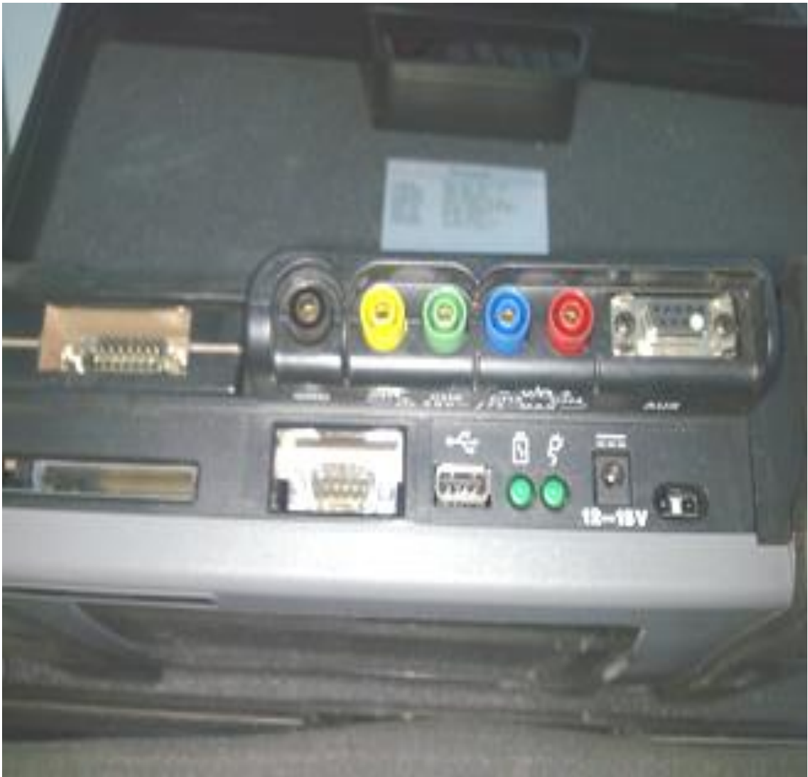
Рисунок 3.4 - Задня панель мотор-тестера з виходами каналів
