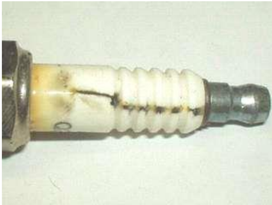
Рисунок 1.14 - Зовнішній пробій ізолятора свічки запалювання
