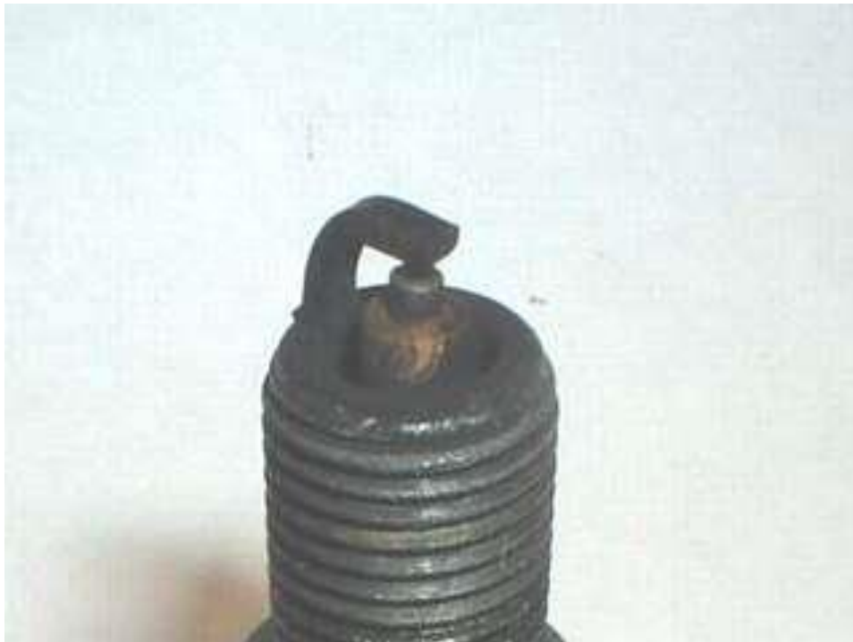
Рисунок 1.7 - Помірно багата суміш
