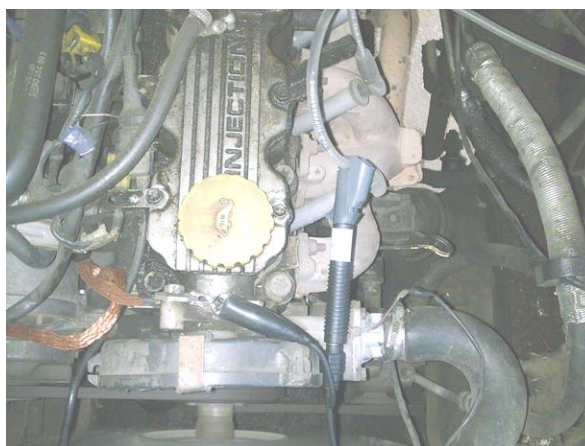
Рисунок 2.2 - Увімкнення мотор-тестера до системи запалювання
