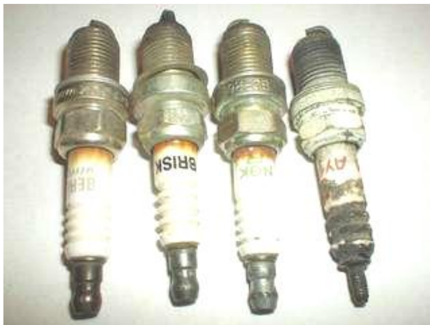
Рисунок 1.12 - Прорив продуктів горіння через неякісне ущільнення свічки
