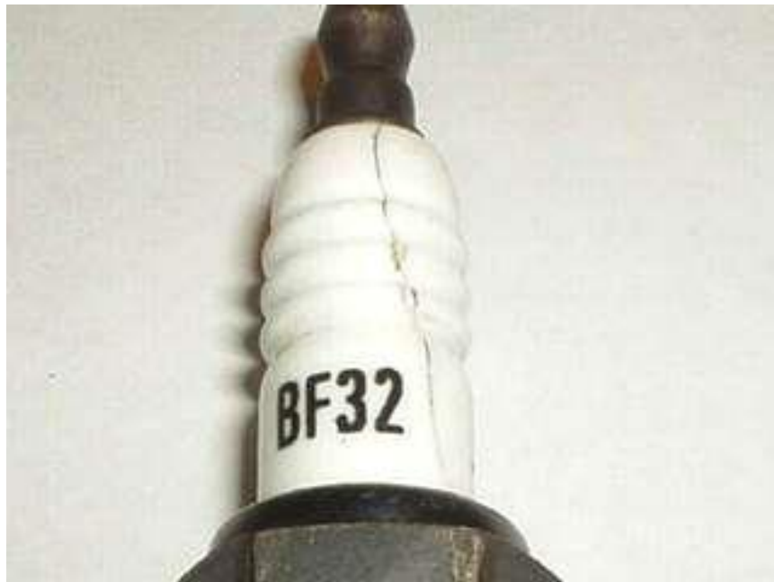
Рисунок 1.13 - Тріщина ізолятора свічки запалювання
