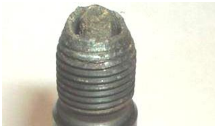
Рисунок 1.11 - Неправильний підбір свічки
