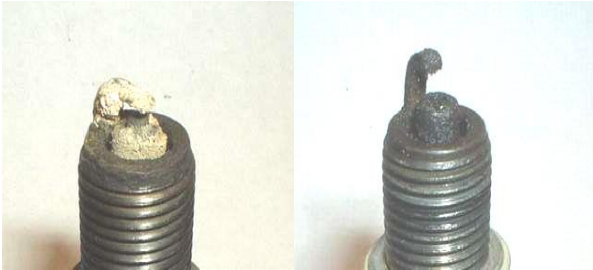
Рисунок 1.5 - Відсутність нормального тепловідведення краю нагару на бічному електроді при підвищеному тепловому режимі
