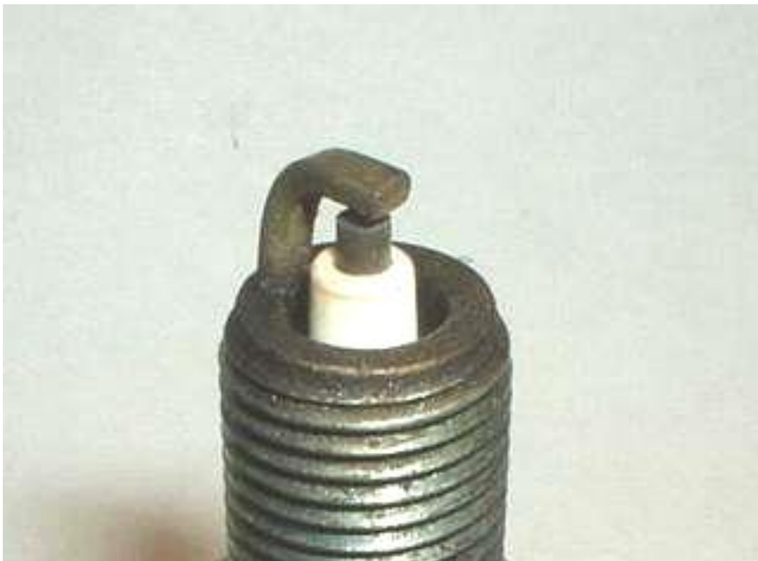
Рисунок 1.6 - Перезбідна паливна суміш
