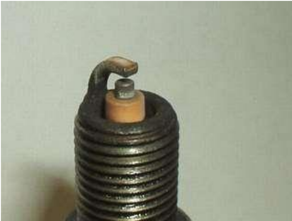
Рисунок 1.3 - Справно працююча свічка
