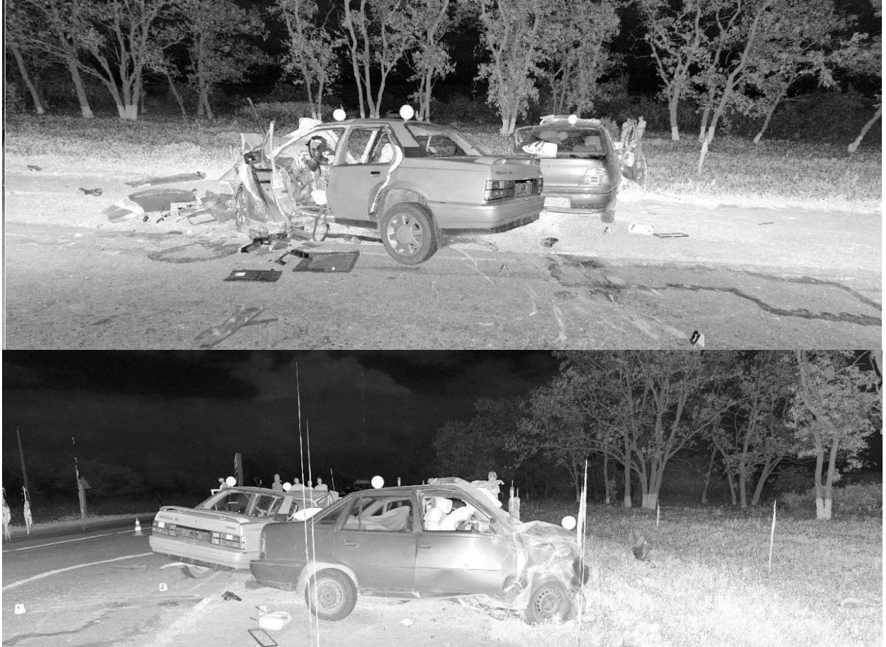
Рис. 10.3. Зображення місця ДТП, що отримані після лазерного сканування з різних ракурсів.
