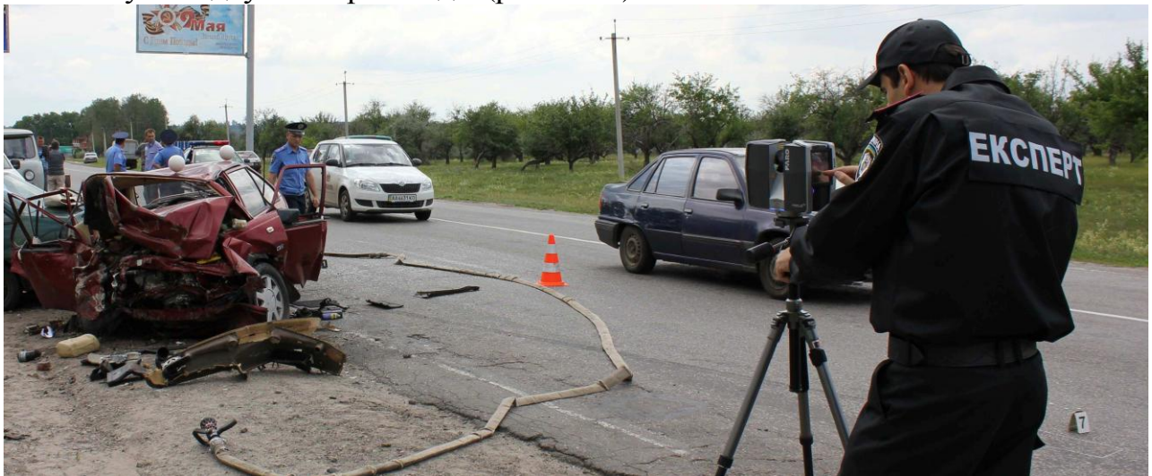
Рис. 10.2. Лазерне сканування ділянки дороги експертом-автотехніком під час огляду місця ДТП.
