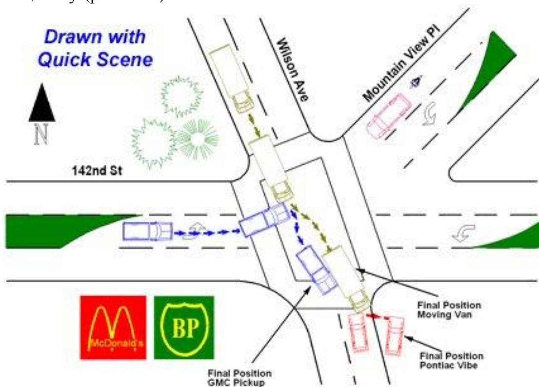
Рис. 12.3. Проект схеми ДТП у програмі «Quick Scene» з відображенням характеру руху транспортних засобів та їх взаємного розташування.
