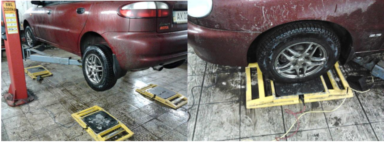
Рис. 8.8. Зважування автомобіля на електронних вагах.
