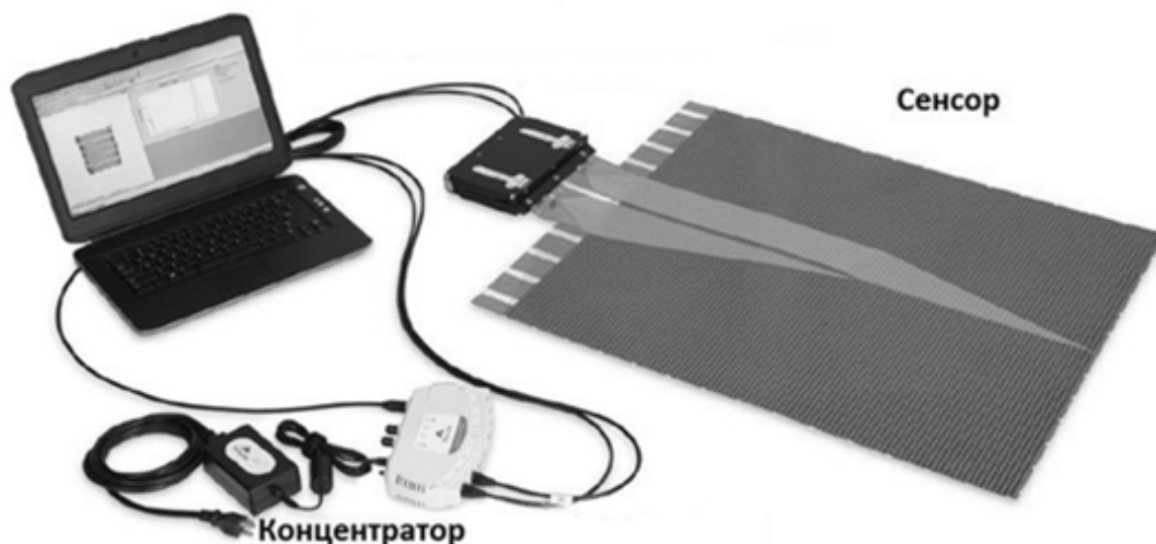
Рисунок 1 – Стенд для определения площади пятна контакта шин с пьезокристаллическими датчиками
