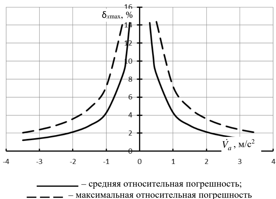
Рисунок 3 – График изменения средней и максимальной относительных погрешностей определения продольного линейного ускорения автомобиля на уклоне с учетом поправки \varepsilon
